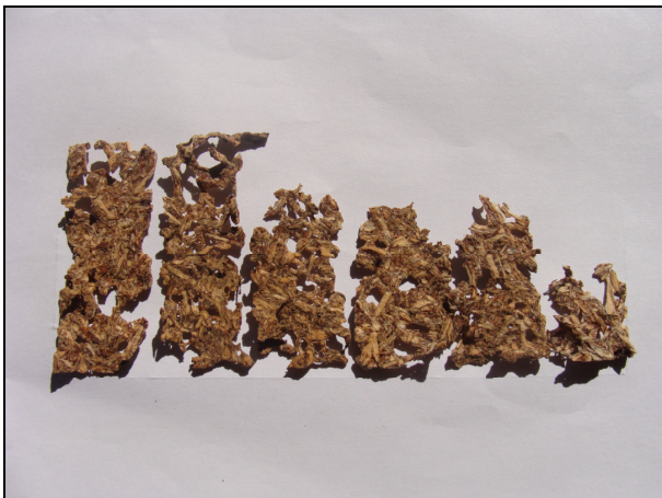
Figura 11: Amostras de chapas de madeira aglomerada fabricadas com adesivo TF de acácia + eucalipto 45% (90:10) a 6 min., submetidas ao ataque de C. gestroi por 90 dias.
