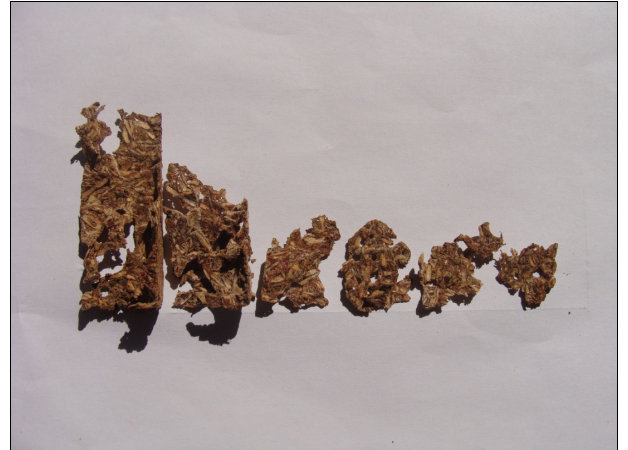
Figura 4: Amostras de chapas de madeira aglomerada fabricadas com adesivo TF de acácia 45% a 9 min., submetidas ao ataque de C. gestroi por 90 dias.
