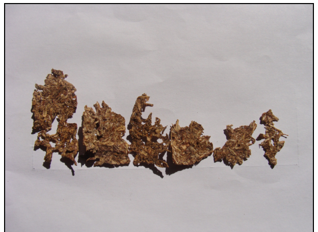
Figura 14: Amostras de chapas de madeira aglomerada fabricadas com adesivo TF de acácia + eucalipto 45% (80:20) a 9 min., submetidas ao ataque de C. gestroi por 90 dias.
