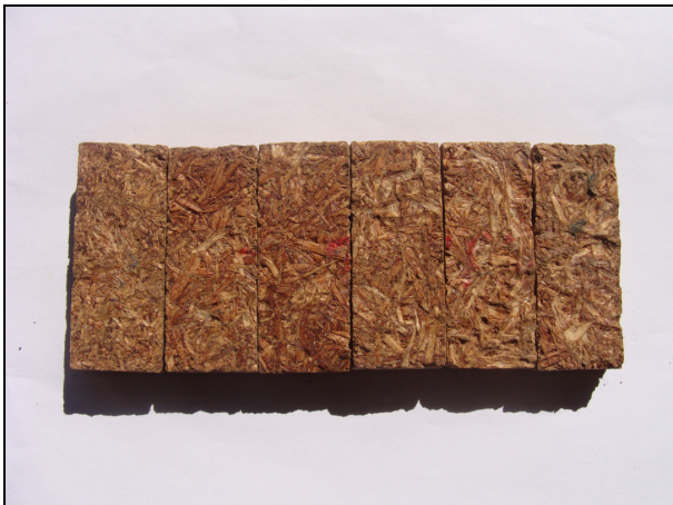
Figura 5: Amostras de chapas de madeira aglomerada fabricadas com adesivo FF a 6 min., submetidas ao ataque de C. gestroi por 90 dias.
