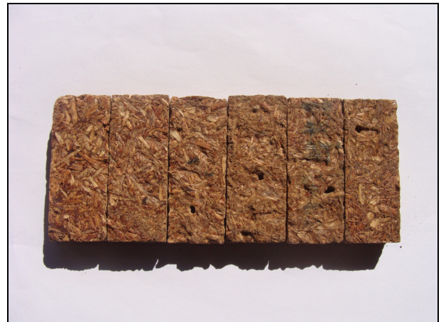
Figura 6: Amostras de chapas de madeira aglomerada fabricadas com adesivo FF a 9 min., submetidas ao ataque de C. gestroi por 90 dias.
