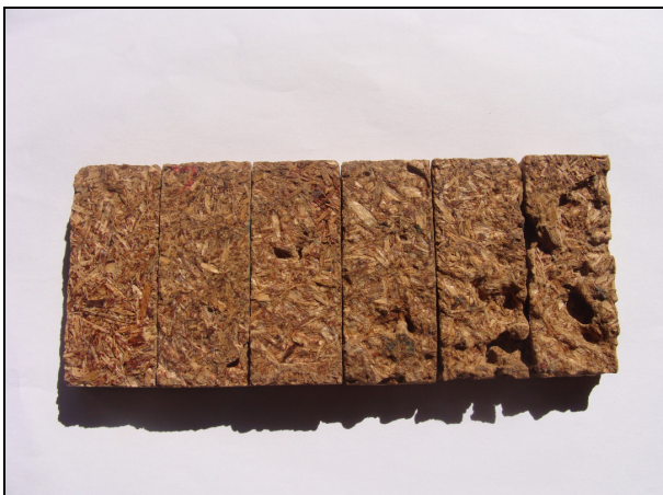
Figura 7: Amostras de chapas de madeira aglomerada fabricadas com adesivo FF+TF de acácia 45% (90:10) a 6 min., submetidas ao ataque de C. gestroi por 90 dias.
