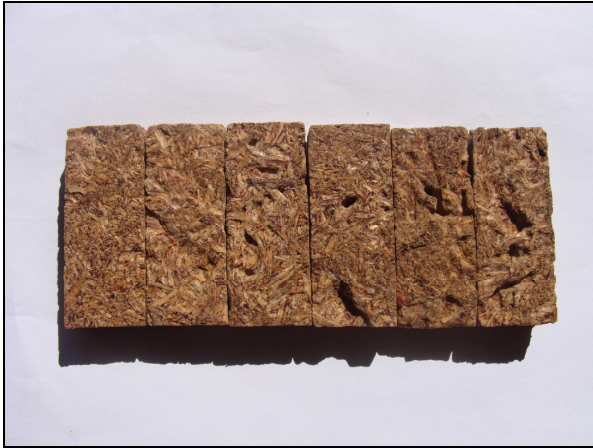
Figura 9: Amostras de chapas de madeira aglomerada fabricadas com adesivo FF+TF de acácia 45% (80:20) a 6 min., submetidas ao ataque de C. gestroi por 90 dias.
