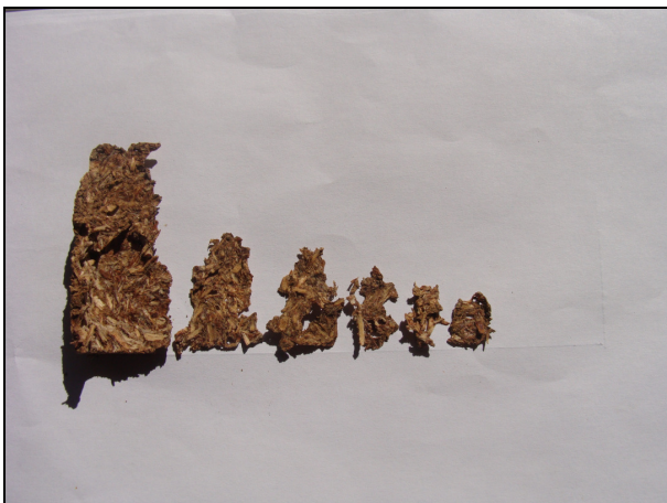
Figura 13: Amostras de chapas de madeira aglomerada fabricadas com adesivo TF de acácia + eucalipto 45% (80:20) a 6 min., submetidas ao ataque de C. gestroi por 90 dias.
