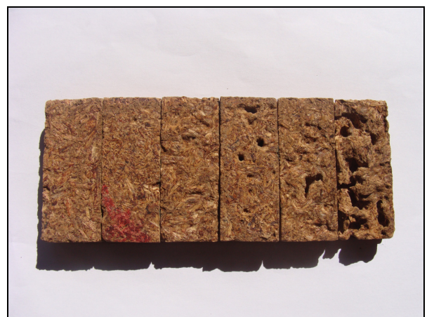
Figura 8: Amostras de chapas de madeira aglomerada fabricadas com adesivo FF+TF de acácia 45% (90:10) a 9 min., submetidas ao ataque de C. gestroi por 90 dias.
