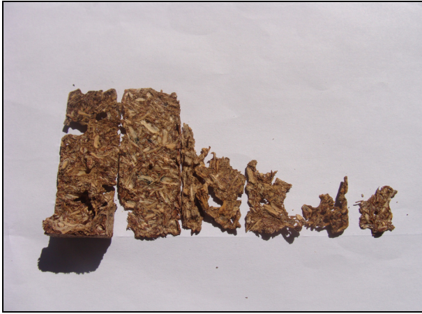
Figura 3: Amostras de chapas de madeira aglomerada fabricadas com adesivo TF de acácia 45% a 6 min., submetidas ao ataque de C. gestroi por 90 dias.
