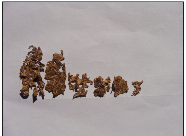
Figura 12: Amostras de chapas de madeira aglomerada fabricadas com adesivo TF de acácia + eucalipto 45% (90:10) a 9 min., submetidas ao ataque de C. gestroi por 90 dias.
