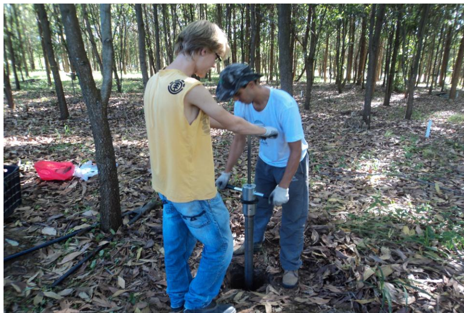
Figura 2: Amostragem de raízes finas com a sonda em um dos pontos escolhidos
