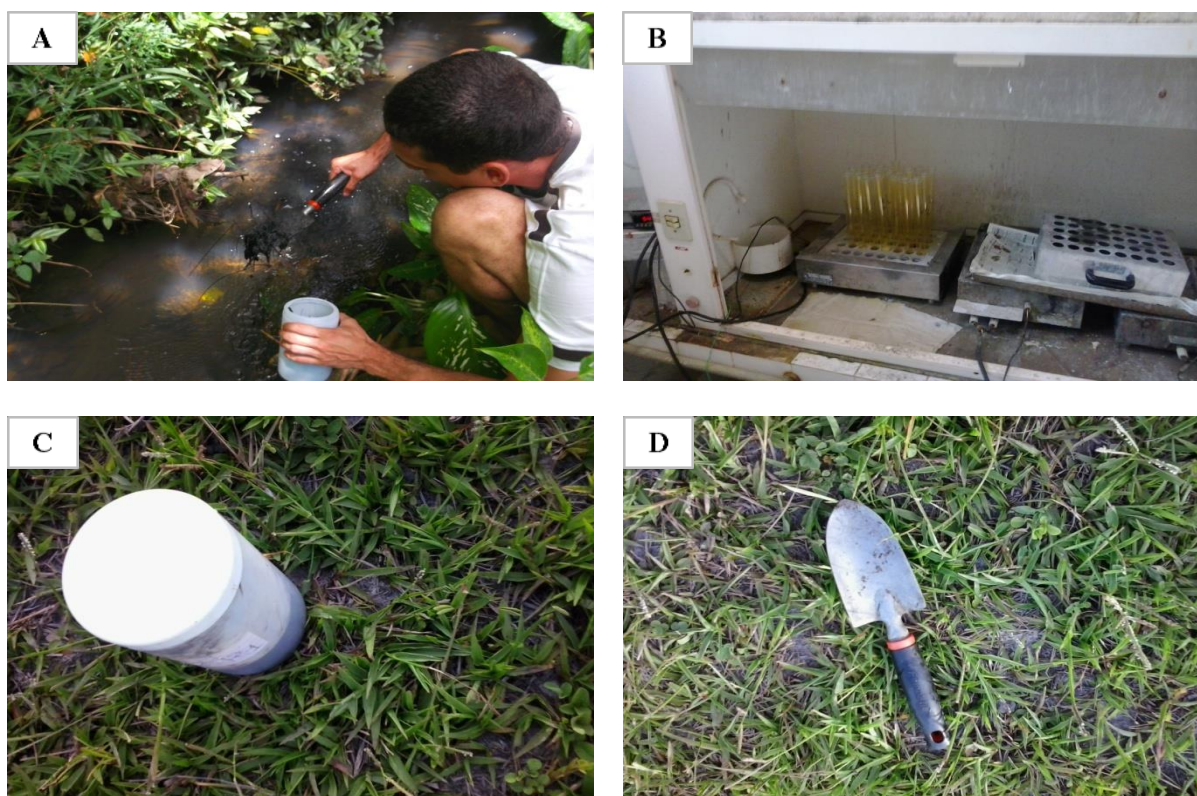
Figura 5. A- Coleta de sedimento as margens do córrego. B- Digestor para análise de metais. C- Potes plásticos de 1,5 litros. D- Espátula utilizada para coleta de sedimentos.
