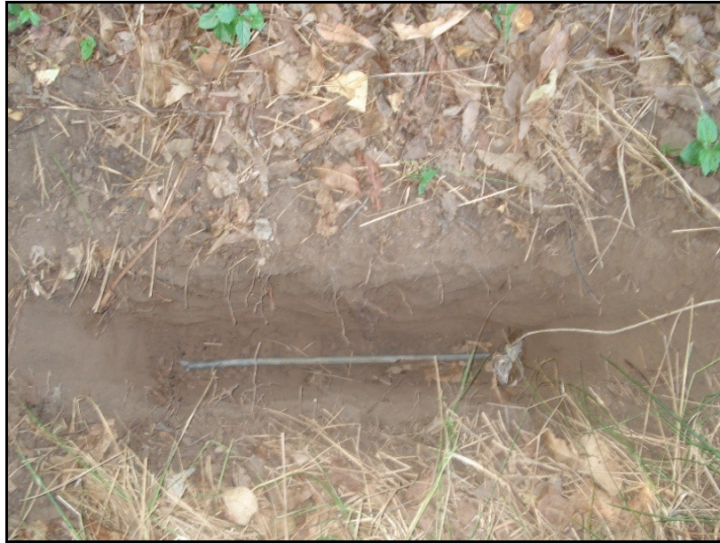
Figura 6: Barra de ferro utilizado para a estimativa da profundidade do Radargrama.
