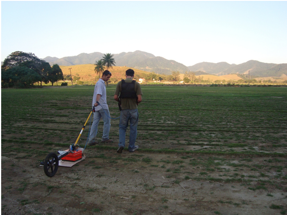
Figura 15: Passagem do georadar na área com gramínea.
