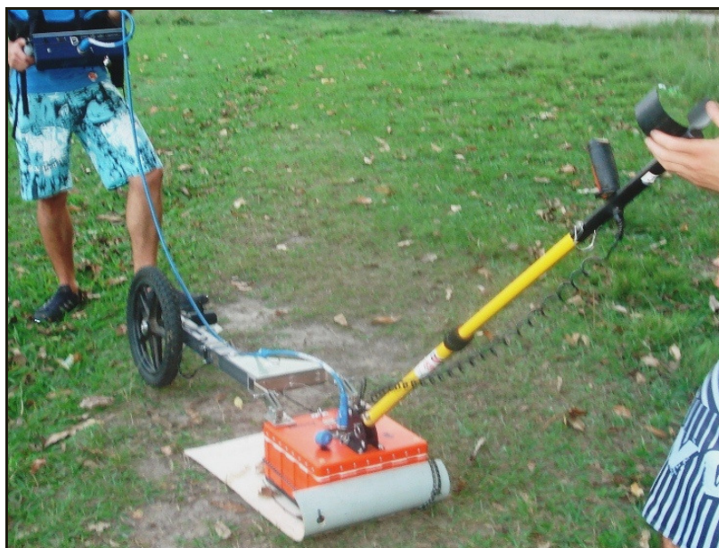
Figura 8: GPR Sendo Tracionado na Área de Transição entre Pastagem e a Floresta de Eucalipto.
