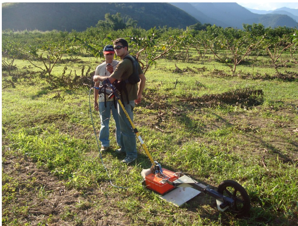
Figura 10: Passagem do georadar na área com goiaba
