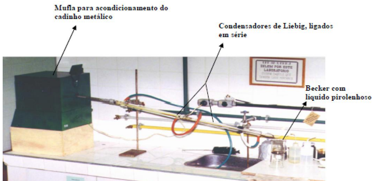
Figura 2. Sistema laboratorial para a destilação seca da biomassa florestal.
