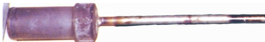
Figura 1. Cadinho metálico, utilizado para a destilação seca da biomassa florestal.
