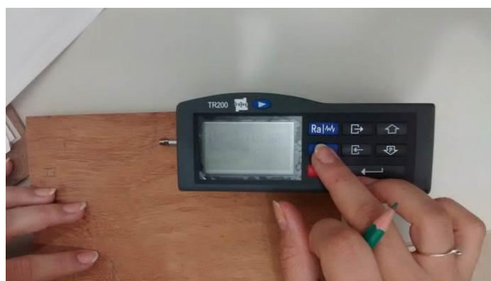
Figura 13. Rugosímetro de contato portátil digital TR200.
