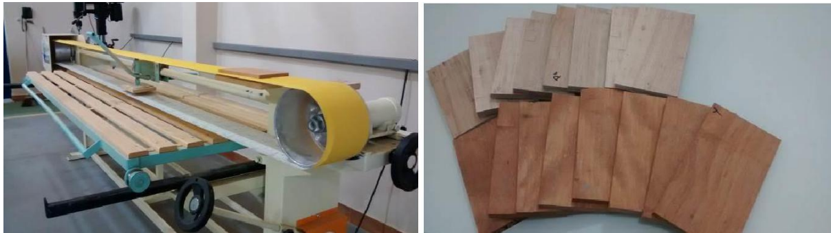
Figura 12. Lixadeira de cinta, modelo Possamai PXA -7200 utilizada no processo de lixamento e corpos de prova utilizados nos testes de usinagem.
