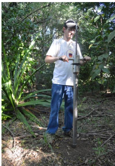
Figura 3: Coleta de solo com o auxílio da sonda no sistema agroflorestal da Fazendinha Agroecológica do km 47.
