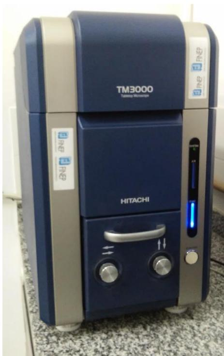
**Figura 7:** Microscópio eletrônico de varredura.
