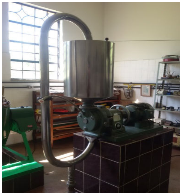
Figura 2 - Refinador Bauer, utilizado para a desagregação das fibras secundárias.
