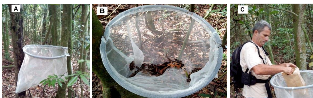
Figura 7: A e B Instalação dos coletores cônicos na pedoforma côncava e na pedoforma convexa; C coleta do material retido nos coletores. Fonte: Menezes, C. E. G., 2013.
