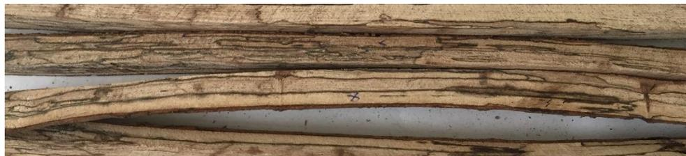
Figura 17- Amostra da parte inferior da madeira da espécie *C. fairchildiana* atacada por fungos manchadores.
