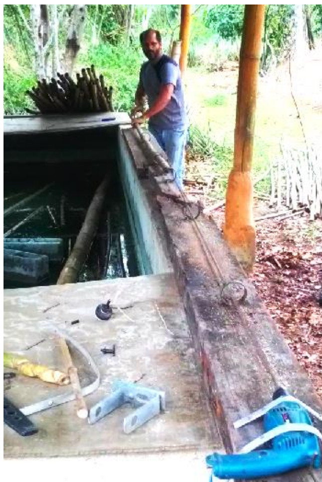
Figura 9: Protótipo da furadeira com vergalhão para perfurar os entrenós dos bambus de menor diâmetro. (fotos: Leonardo Monteiro)
