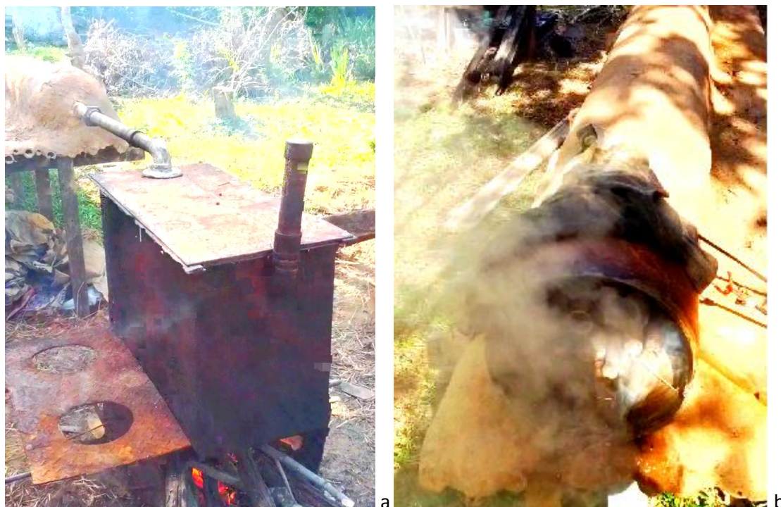
Figura 15a: caldeira para aquecer Phyllostachys sp. Feitos a partir de materiais recicláveis, bambu e barro. Figura 15b: Câmara para conter o vapor e aquecer os bambus. (fotos: Ivan lobo)
