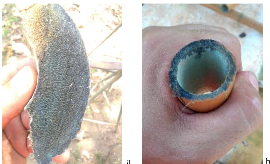
Figura 13: a) teste colorimétrico para avaliar a penetração e distribuição de sais de cobre e boro em Bambusa vulgares . (foto: Leonardo Monteiro) b) teste colorimétrico para avaliar a penetração e distribuição de sais de cobre e boro em Phyllostachys aurea . (foto: Leonardo Monteiro)
