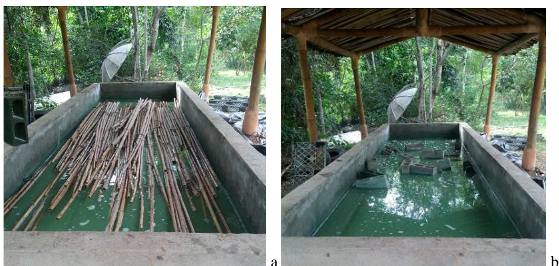
Figura 12: a) Colmos de Bambusa tuldoides antes de serem submersos na solução preservativa. (foto: Ivan lobo).
