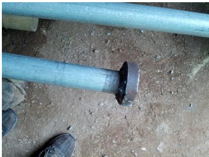
Figura 10: barra de ferro para perfurar entrenós de bambus de maior diâmetro. (foto: Leonardo Monteiro)
