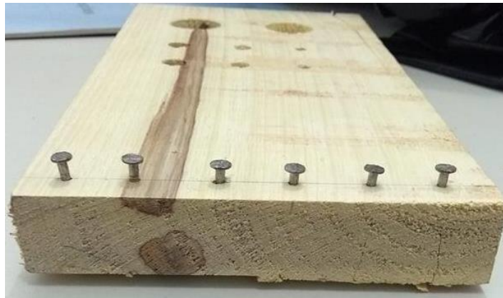
Figura 15: Corpo de prova após teste de fendilhamento por pregos.
