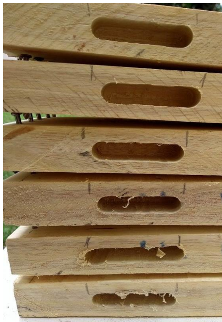
Figura 18: Diferentes intensidade de levantamento das fibras apresentadas nos corpos de prova após do Teste do Rasgo.
