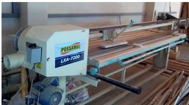
Figura 10: Lixadeira de esteira com aproximadamente 2,7 m de comprimento usada para realização do teste da lixa.
