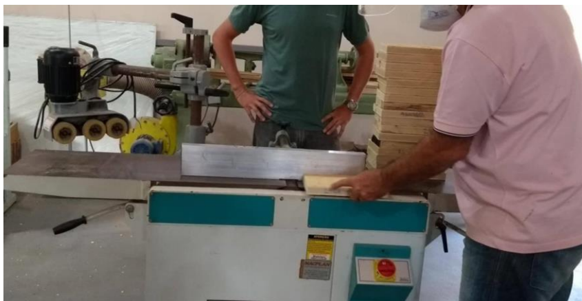
Figura 9: Corpos de provas do Pau Sangue sendo passados na plaina.
