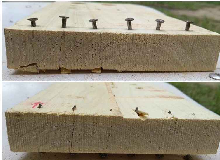
Figura 19: Corpos de prova com presença de rachaduras e trincas após teste de Fendilhamento por pregos
