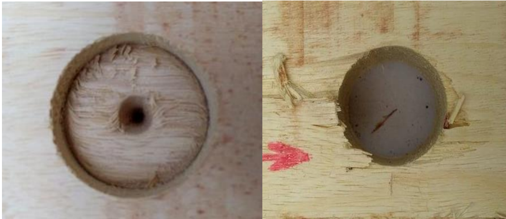
Figura 17: Defeitos com maior ocorrência no teste de furação feita por furadeira vertical de coluna equipada com broca chata em furos não passantes e passantes.
