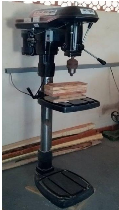
Figura 12: Furadeira vertical de coluna com avanço manual usada para os testes de furação.
