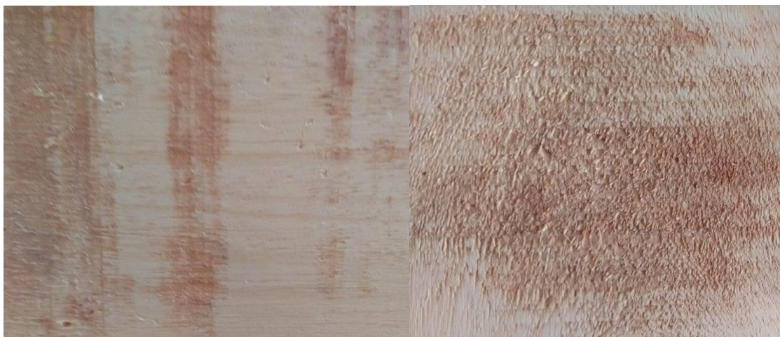
Figura 16: Defeitos de riscamento e grãs felpudas com maior ocorrência nos corpos de prova após passarem pelo Teste da Lixa
