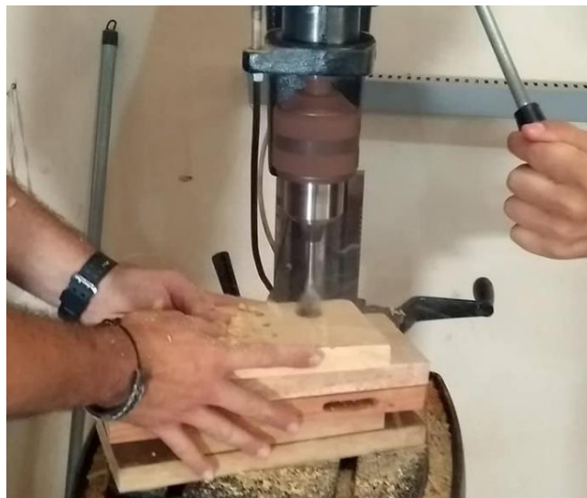
Figura 13: Furação do tipo dobradiça passante.
