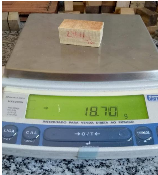
Figura 6: Amostras para teste das propriedades físicas sendo pesadas em balança digital.
