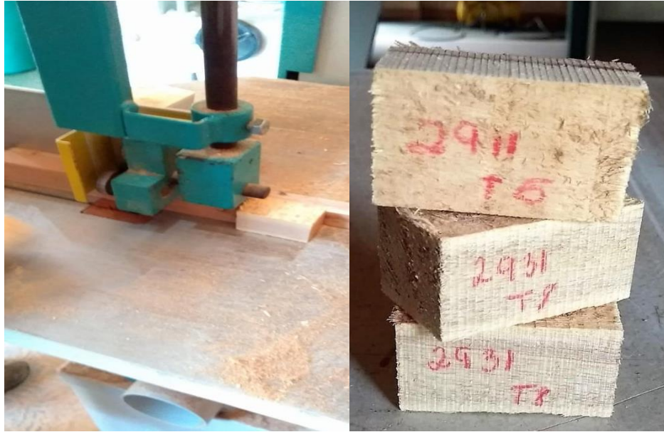
Figura 5: Corpos de Prova para a caracterização das propriedades físicas da madeira sendo feitos por serra de fita.
