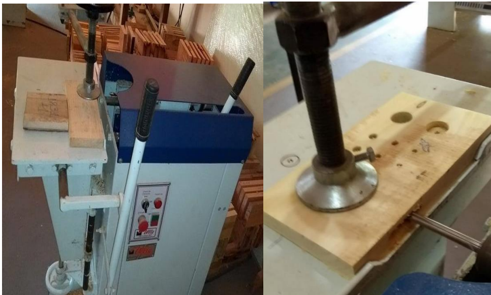
Figura 14: Furadeira tipo horizontal utilizada para o teste do rasgo e detalhe do corpo de prova em operação.
