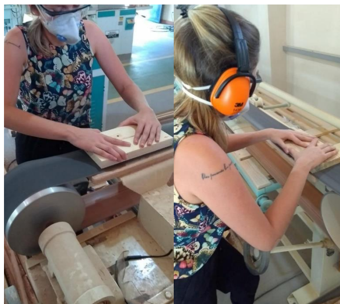
Figura 11: Amostras de Pau Sangue sendo passadas na lixadeira de esteira por aproximadamente 20 segundos cada.
