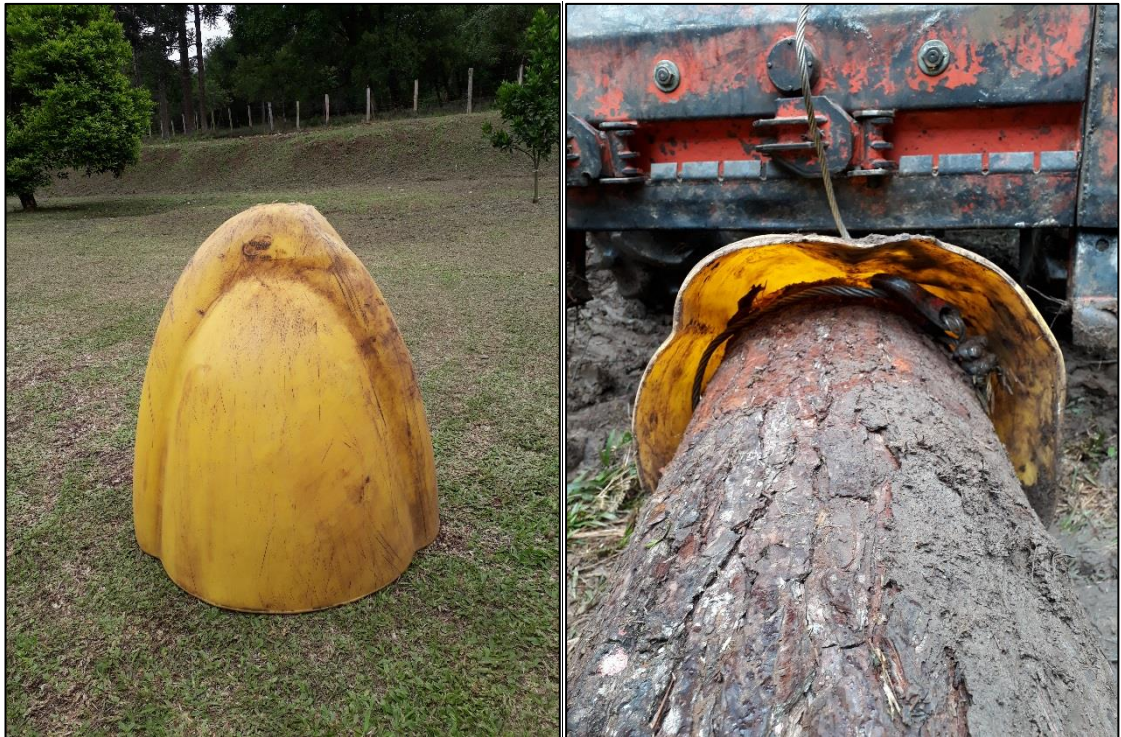
Figura 9a e 9b. Skidding Cone utilizado com o objetivo de reduzir o impacto da tora no solo, no arraste e guinchamento de toras, nos tratamentos 2 e 4.
