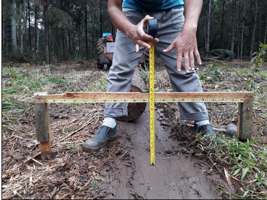
Figura 11. Medição da profundidade do sulco com auxílio do perfilômetro, no tratamento 2, linha 7, sexta passagem da tora na parcela.
