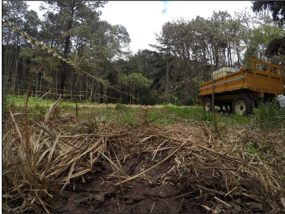
Figura 18. Aspecto da profundidade do solo no Tratamento 1, arraste da tora sem a utilização do Skidding Cone , após 18 passagens da tora.
