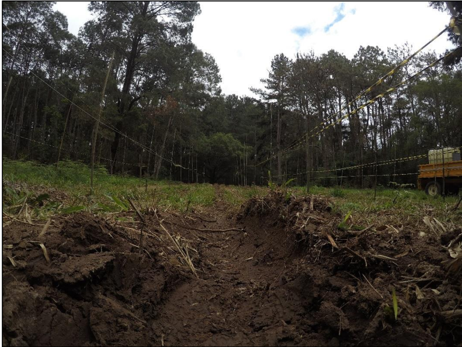
Figura 20. Aspecto da profundidade do solo no Tratamento 3, guinchamento da tora sem a utilização do Skidding Cone , após 18 passagens da tora.
