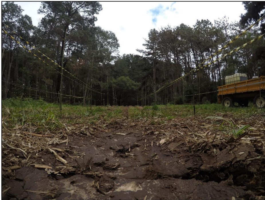
Figura 19. Aspecto da profundidade do solo no Tratamento 2, arraste da tora com a utilização do Skidding Cone , após 18 passagens da tora.
