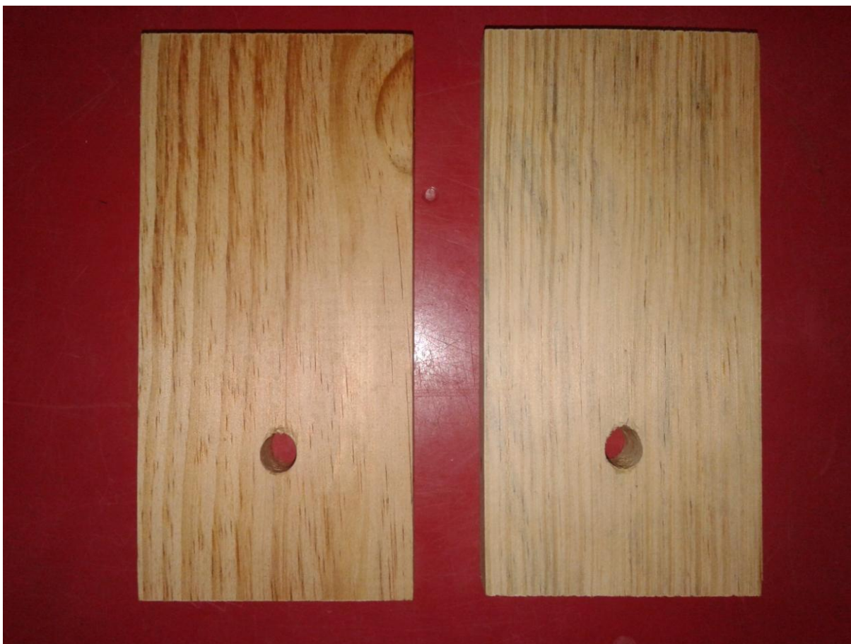
Figura 4: Corpos de prova, da espécie Pinus caribaea var. caribaea , para ensaio de embutimento paralelo com lenho de cerne (esquerda) e alburno (direita).
