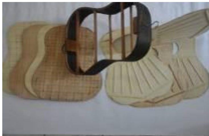
Figura 31-Laterais com travessas e reforços e tamos harmônicos e fundos Fonte: (FLORES, 2015).
