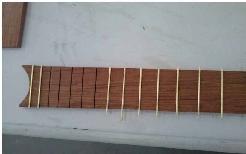
Figura 29- Escala em madeira de Jatobá sendo colocados os trastes. Fonte: (SOARES, 2014).
