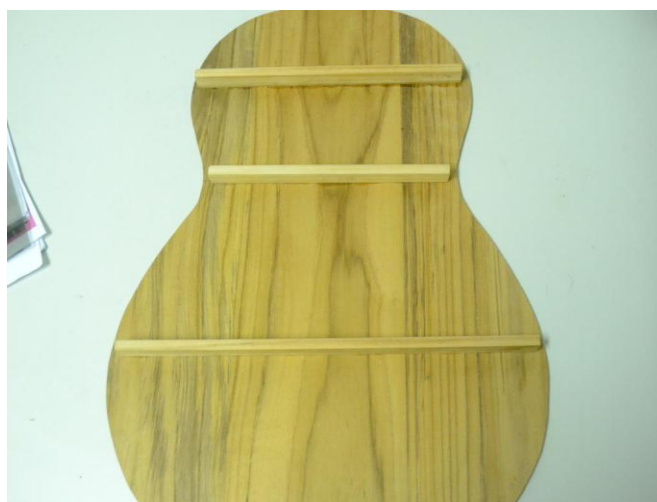
Figura 25- Fundo do violão com travessões. Fonte: (SOARES, 2014).
