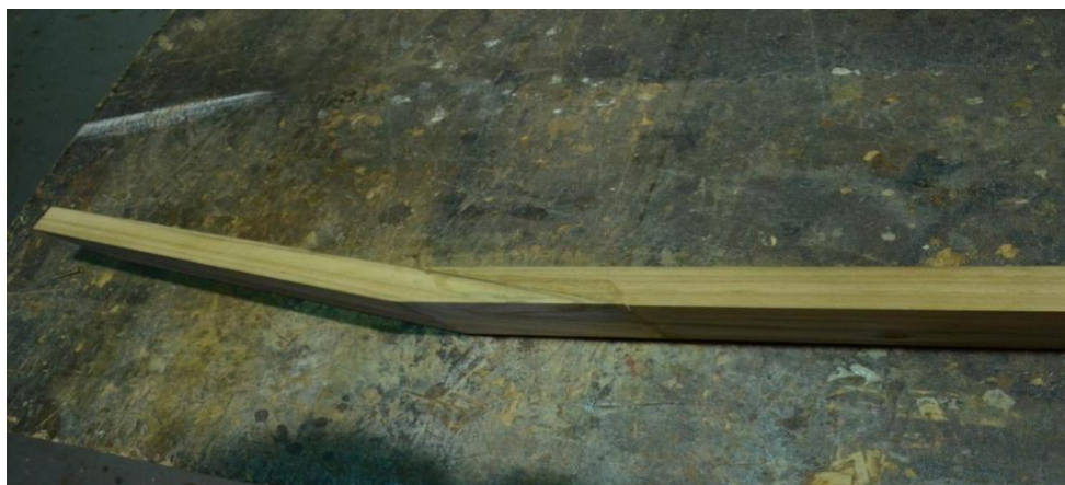
Figura 28- Braço e mão do instrumento. Fonte: (SOARES, 2014).
