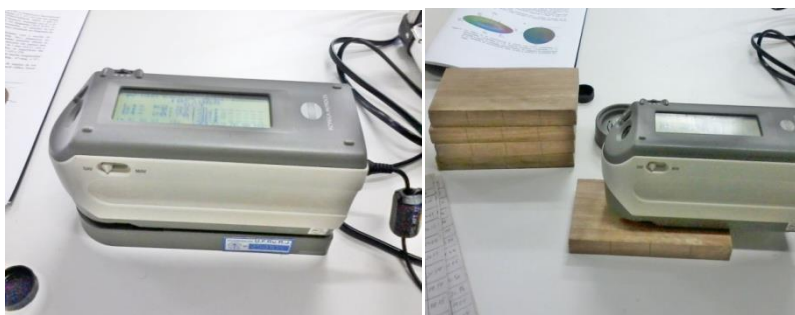
Figura 8. Espectrofotômetro utilizado para mensurar as cores das espécies de acordo com as normas do CIE. (Espectrofotômetro portátil 2600d da Konica Minolta)
