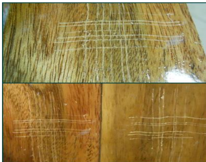
Figura 11. Teste de grade para testar a aderência do verniz.
