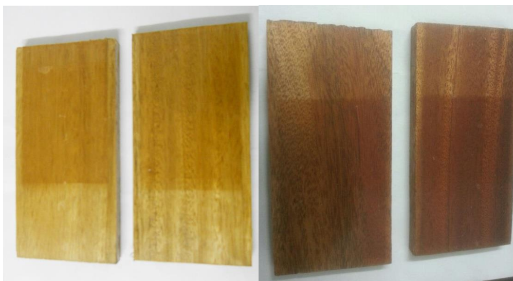
Figura 10. Corpos-de-prova após o envelhecimento acelerado.
