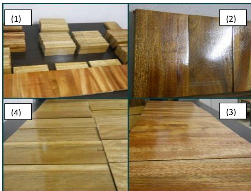
Figura 6. No sentido horário (1) peças separadas e envernizadas, (2) brilho das peças de mogno africano, (3) peças de mogno africano envernizadas, (4) peças de C. citriodora envernizadas.
