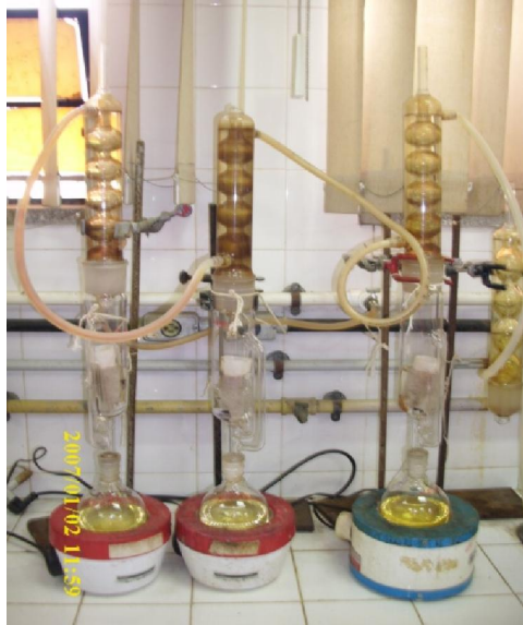
Figura 8. Processo de extração pelo aparelho tipo Soxhlet.
