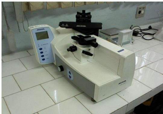
**Figura 2** - Micrótomo de deslize utilizado para fazer os cortes histológicos.
