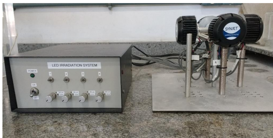
Figura 6 - Sistema de irradiação personalizado, com quatro LED's.
