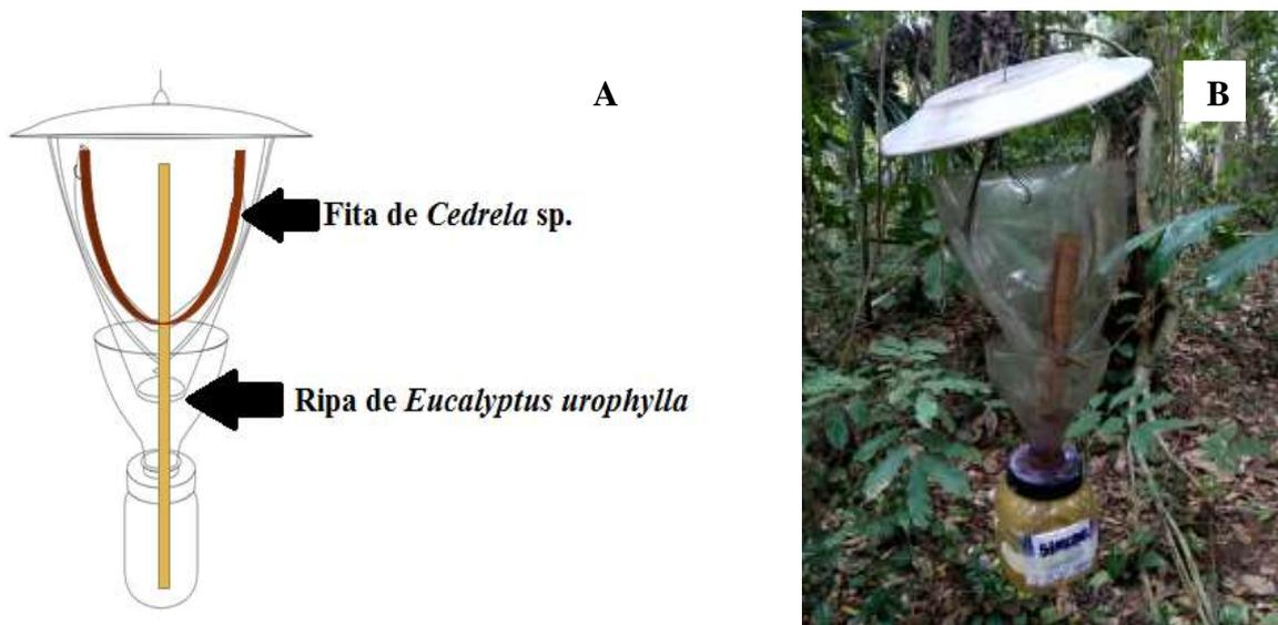
Figura 5: (A) Esquema da armadilha Semifunil com a modificação 2 (Mod 2 C-01 e C-02) com a incorporação das ripas de *Eucalyptus urophylla*, e uma fita de *Cedrela* spp. que foi colocada no interior na mangueira porta isca ficando em contato com o álcool contido no local; (B) Armadilha em campo.
