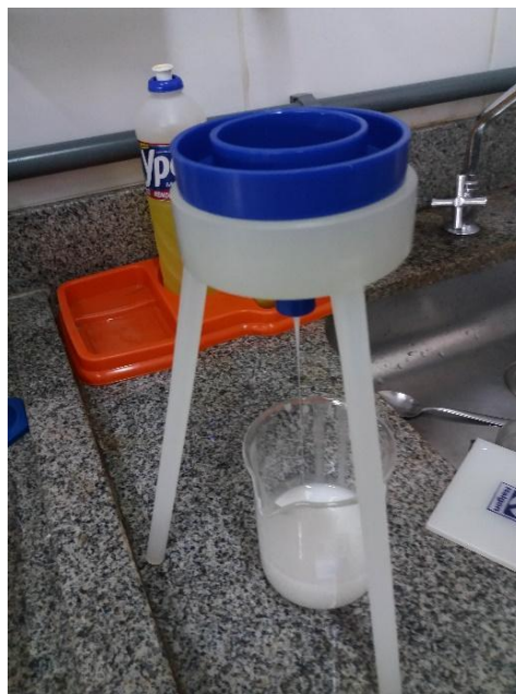
Figura 8. Registro do ensaio de viscosidade do adesivo de ureia-formaldeído no Copo Ford. Fonte: autoria própria.
