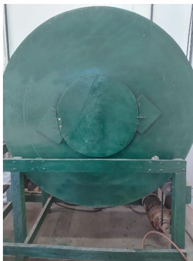
Figura 9. Encoladeira laboratorial contendo pistola de aspersão pneumática do adesivo e com rotação mecânica para homogeneização das partículas.
