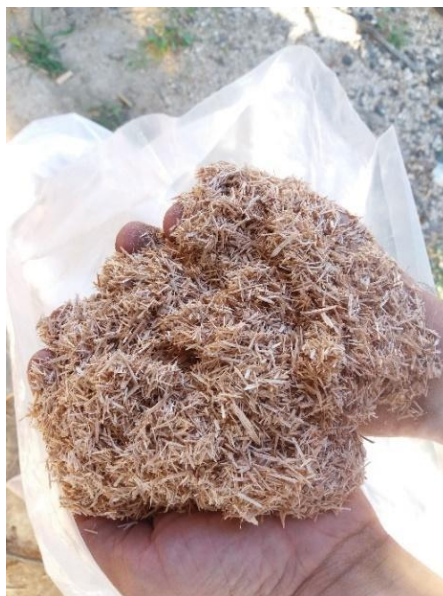
Figura 6. Foto do detalhamento das partículas de eucalipto após a etapa de peneiramento. Fonte: autoria própria.
