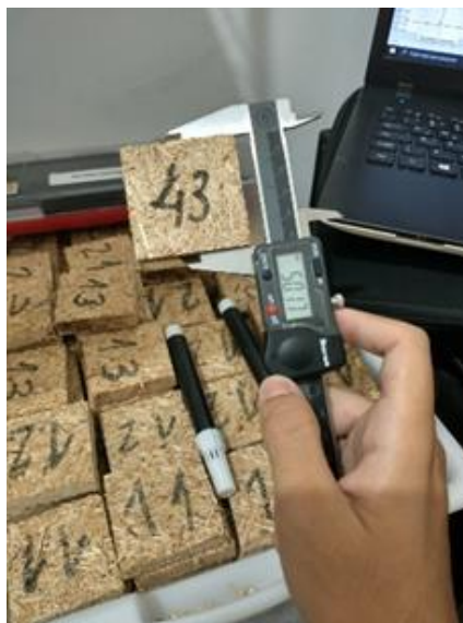
Figura 14. Medição das dimensões exatas dos corpos-de-prova para o cálculo de volume na densidade aparente e da mensuração da espessura inicial antes do inchamento em 24 horas. Fonte: autoria própria.
