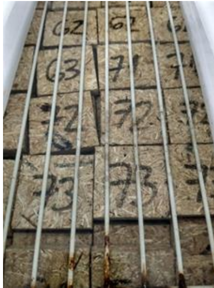
Figura 13. Corpos-de-prova submersos para ensaio de inchamento em 24 horas. Fonte: autoria própria.
