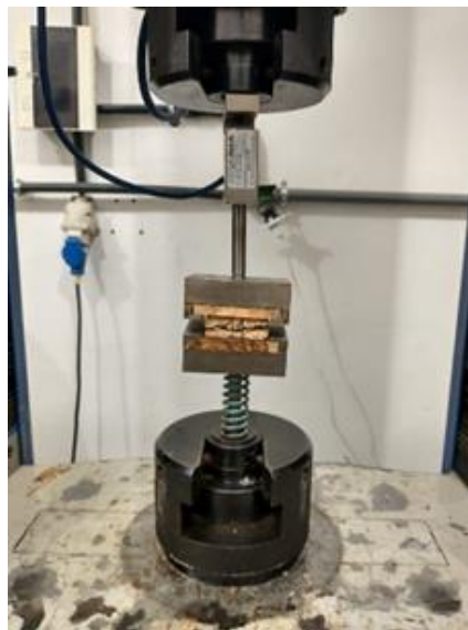
Figura 15. Registro do ensaio de tração perpendicular finalizado com detalhe para o rompimento no miolo do corpo-de-prova. Fonte: autoria própria.
