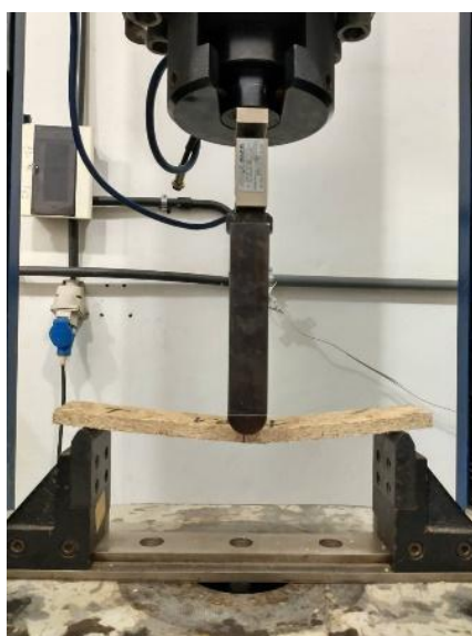
Figura 16. Ensaio de flexão estática finalizado com detalhe na ruptura do corpo-de-prova. Fonte: autoria própria.
