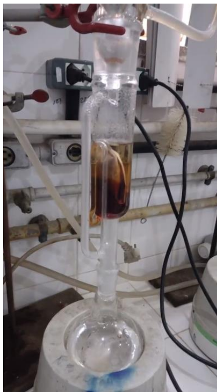
Figura 5 - Extrator Soxhlet e cartucho com pó de Pau-brasil ( Caesalpinia echinata ) Fonte: Laudares (2019).
