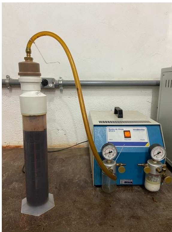
Figura 11 - Amostras inseridas na proveta para receber vácuo com 700 mm de Hg, por um período de 40 minutos. Fonte: Próprio autor (2020).
