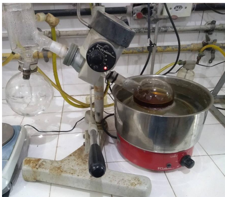
Figura 6 - Rotavapor com a solução de extrativo de Pau-brasil ( Caesalpinia echinata ) Fonte: Laudares (2019).
