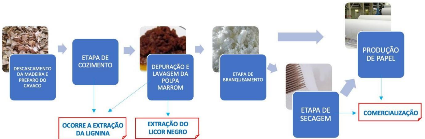
Figura 2 - Fluxograma simplificado do processo kraft para comercialização da celulose e do papel. Fonte: Adaptado de CORREIA (2010).
