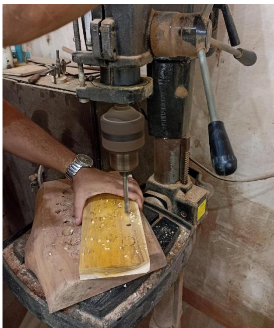
Figura 6. Furadeira vertical utilizada para realizar os furos de cavilha e dobradiça.
