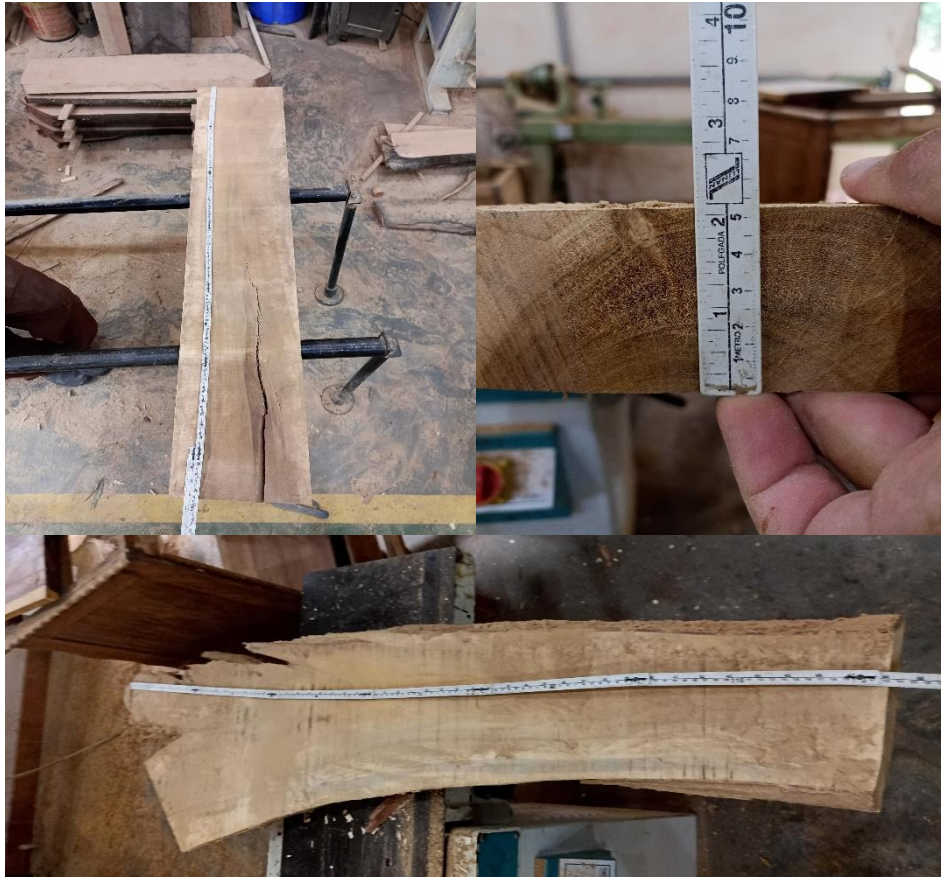
Figura 2. Tábuas de madeira utilizadas para a confecção dos corpos-de-prova. Fonte: Arquivo pessoal.
