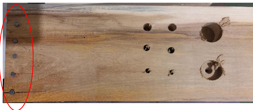
Figura 8. Teste de fendilhamento realizado com pregos.
