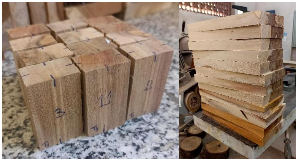
Figura 3. Amostras para propriedades físicas e para usinagem. Fonte: Arquivo pessoal.
