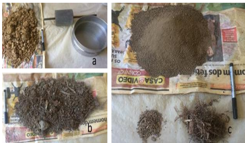
Figura 4: Preparo das amostras de terra. (a) Amostra de terra antes do destorroamento; (b) Durante o destorroamento; e (c) Pós destorroamento (TFSA e material residual retido na peneira).
