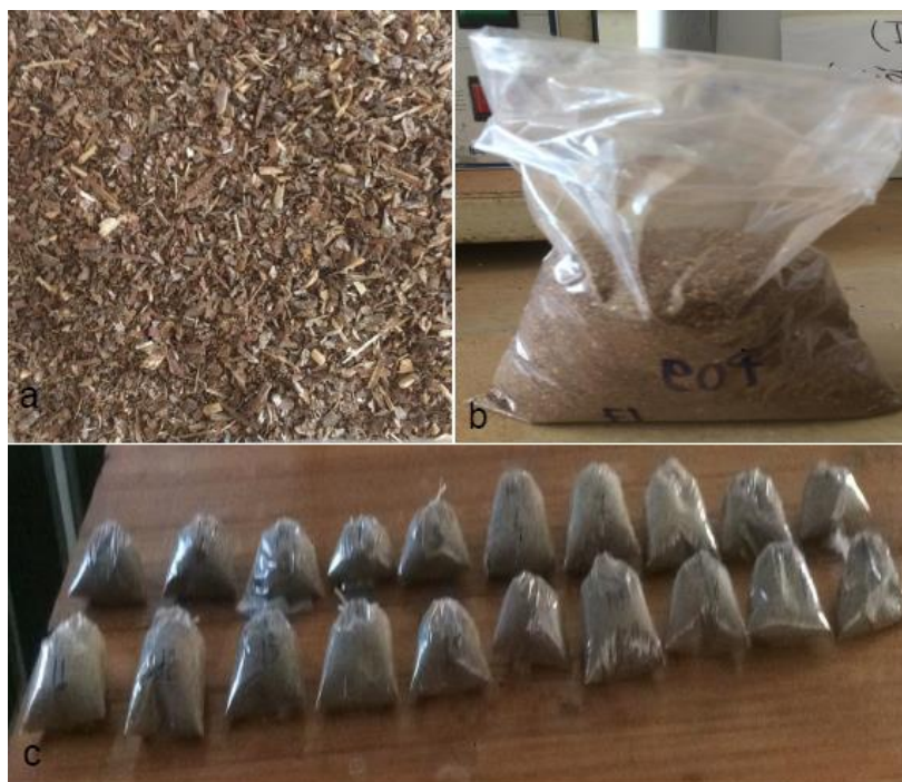
Figura 8: Armazenamento das amostras. (a) Amostra moída de serapilheira; (b) Amostra moída em embalagem para armazenamento; e (c) Amostras de serapilheira moídas, embalada e devidamente identificadas.
