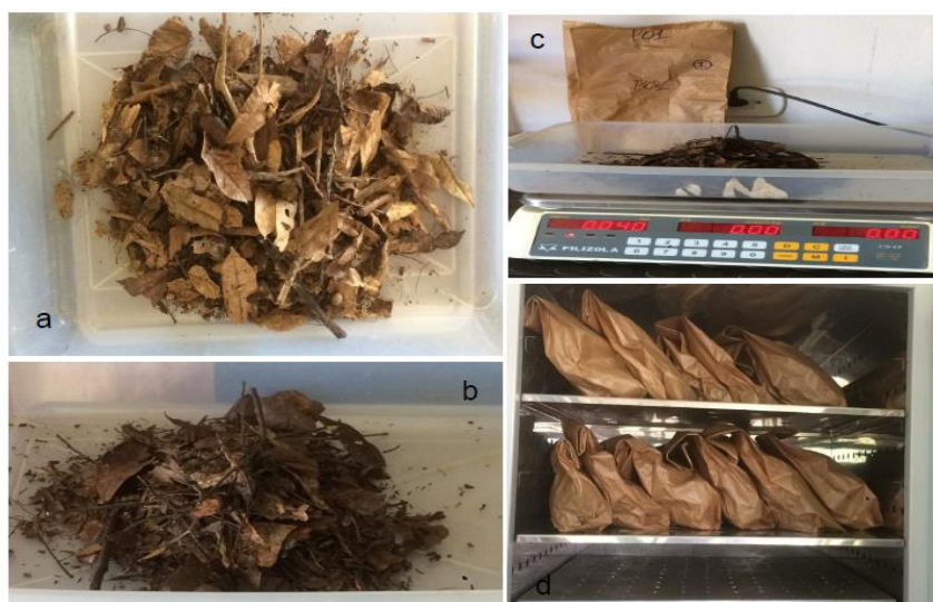
Figura 6: Preparo das amostras de serapilheira. (a e b) Amostras de serapilheira antes da secagem; (c) Pesagem do material; e (d) Amostras de serapilheira durante o processo de secagem em estufa a 50\ ^\circ C .
