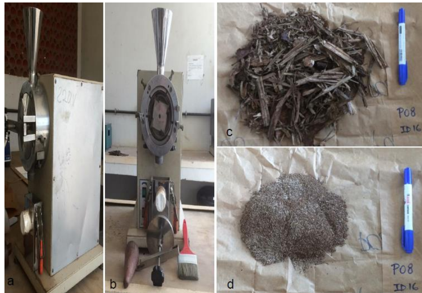
Figura 7: Preparo da serapilheira para as análises químicas. (a) Vista lateral do moinho de facas utilizado na moagem do material; (b) Vista frontal do moinho de facas com protetor frontal desacoplado (para uma melhor observação das facas de moagem) e demais materiais utilizados na moagem da serapilheira; (c) Amostra antes da moagem; e (d) Amostra após a moagem.
