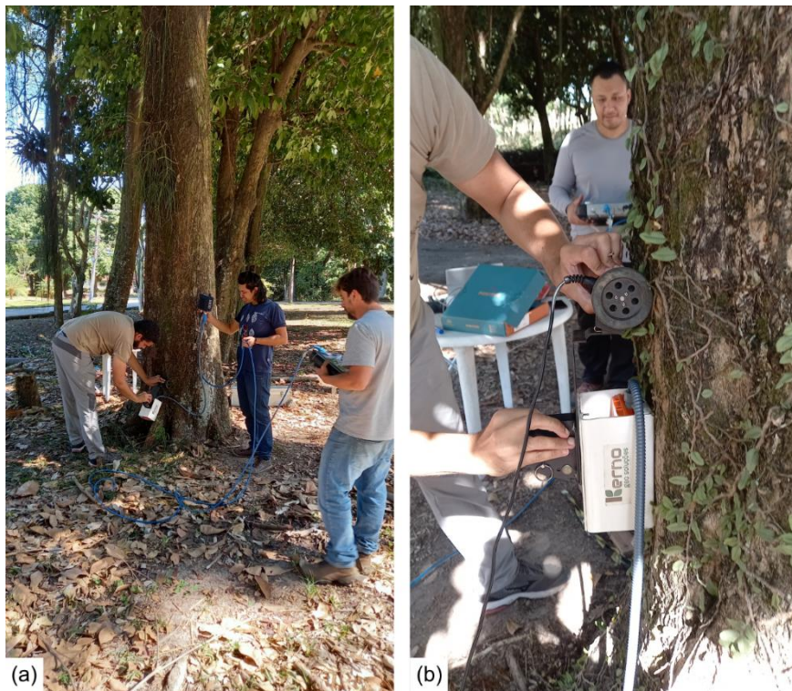
Figura 6: Aquisição de dados utilizando o método GPR. a) Exemplar de munguba analisado. b) Detalhe da antena de 1600 MHz utilizada.
