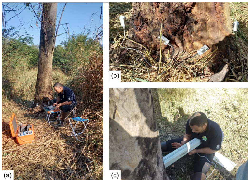
Figura 8: Aquisição de dados utilizando tomógrafo sônico e resistógrafo. a) Exemplar de eucalipto analisado. b) Detalhe dos sensores dispostos no tronco. c) Aquisição de dados de resistografia em eucalipto.
