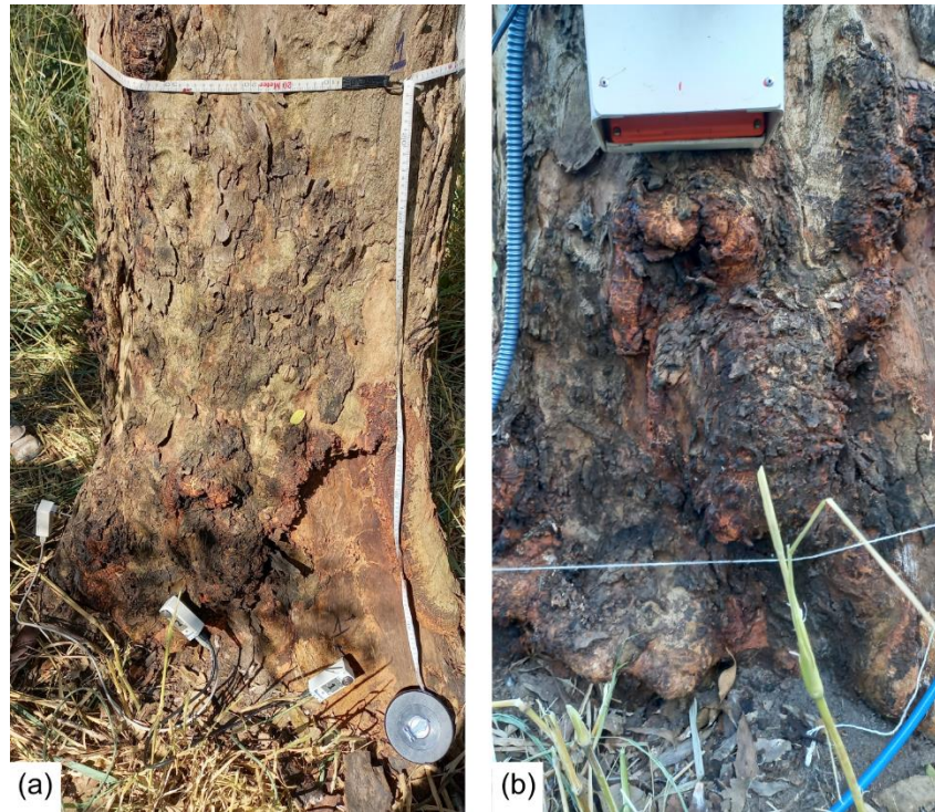
Figura 4: Defeitos encontrados na base dos eucaliptos EU2 (a) e EU3 (b).
