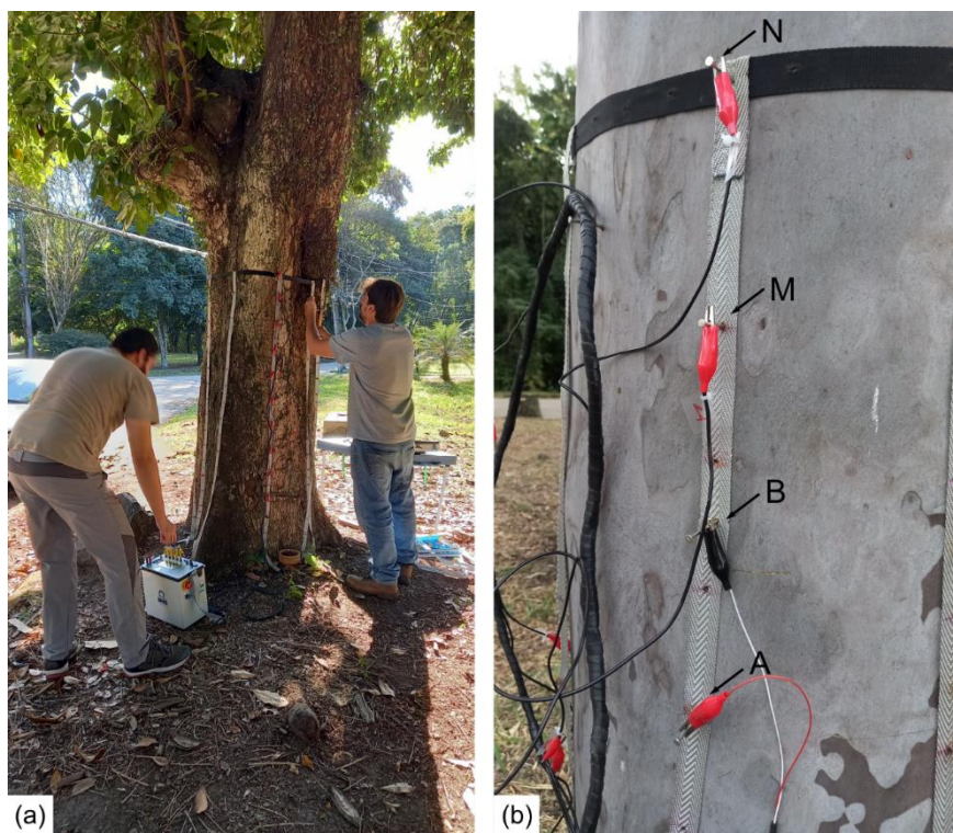
Figura 7: Aquisição de dados utilizando o método da eletrorresistividade. a) Exemplar de munguba analisado. b) Detalhe da disposição dos eletrodos de corrente (A e B) e de potencial (M e N) no tronco.
