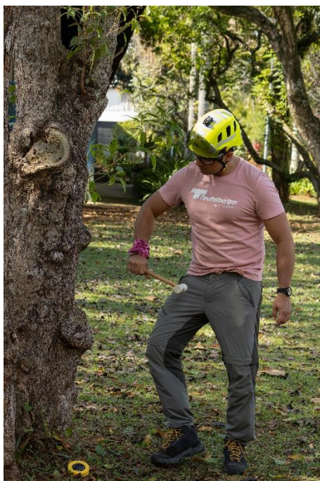
Figura 7: Uso de martelo de borracha para detecção de cavidades internas no tronco
