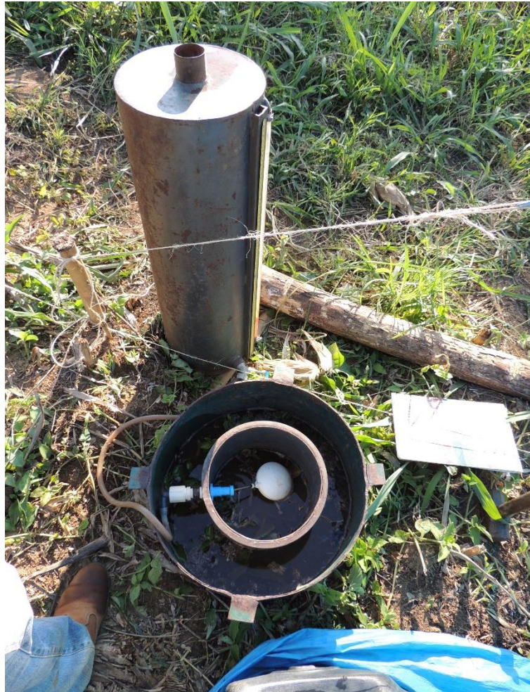
Figura 10. Infiltrômetro de anéis concêntricos e reservatório de água, durante avaliação a campo. (Fonte: arquivo pessoal do autor).
