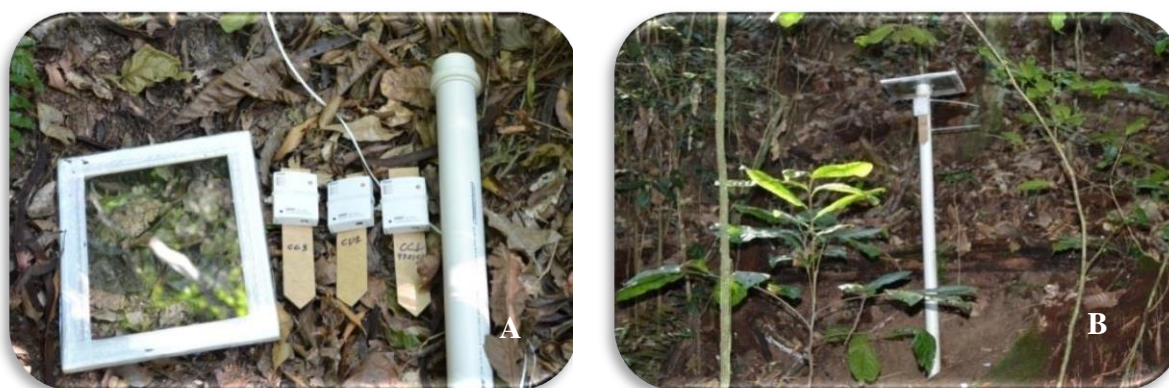
Figura 20. (A) Material utilizado para instalação dos aparelhos; (B) Aparelho HOBO instalado (Medeiros et al., 2015).
