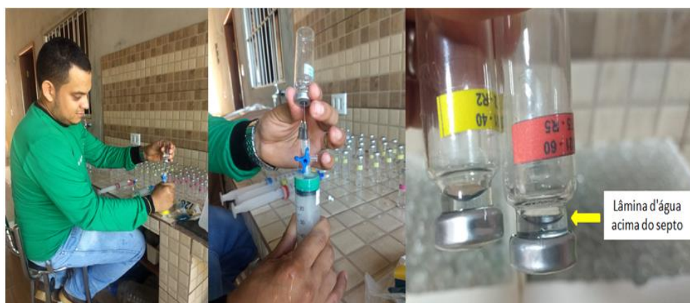
Figura 25. Frascos armazenados com o septo para baixo com lâmina d'água acima do septo para evitar a difusão do gás.
