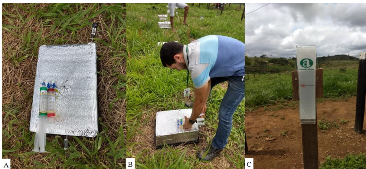
Figura 24. Câmara estática fechada equipada com termômetro tipo espeto (A); Extração dos gases contidos no interior das câmaras utilizando seringas de 60 ml nos intervalos de 0, 20, 40 e 60 minutos (B); Pluviômetro na área experimental para acompanhamento diário da precipitação pluvial (C).
