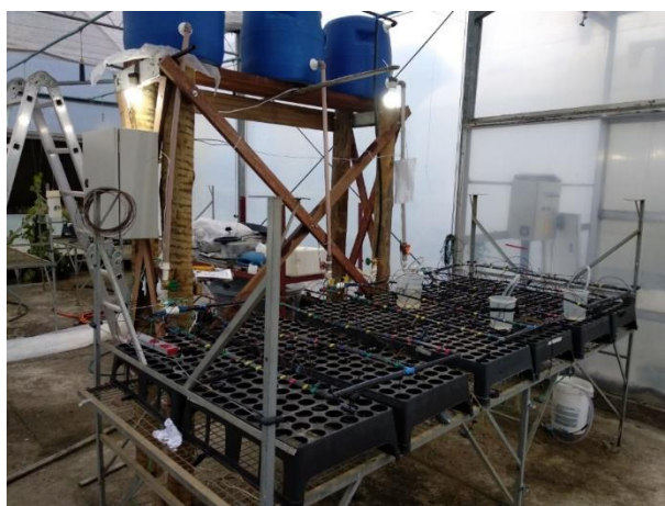
Figura 1. Bancada experimental com três sistemas de microirrigação por gotejamento, abastecidos por reservatórios independentes.
