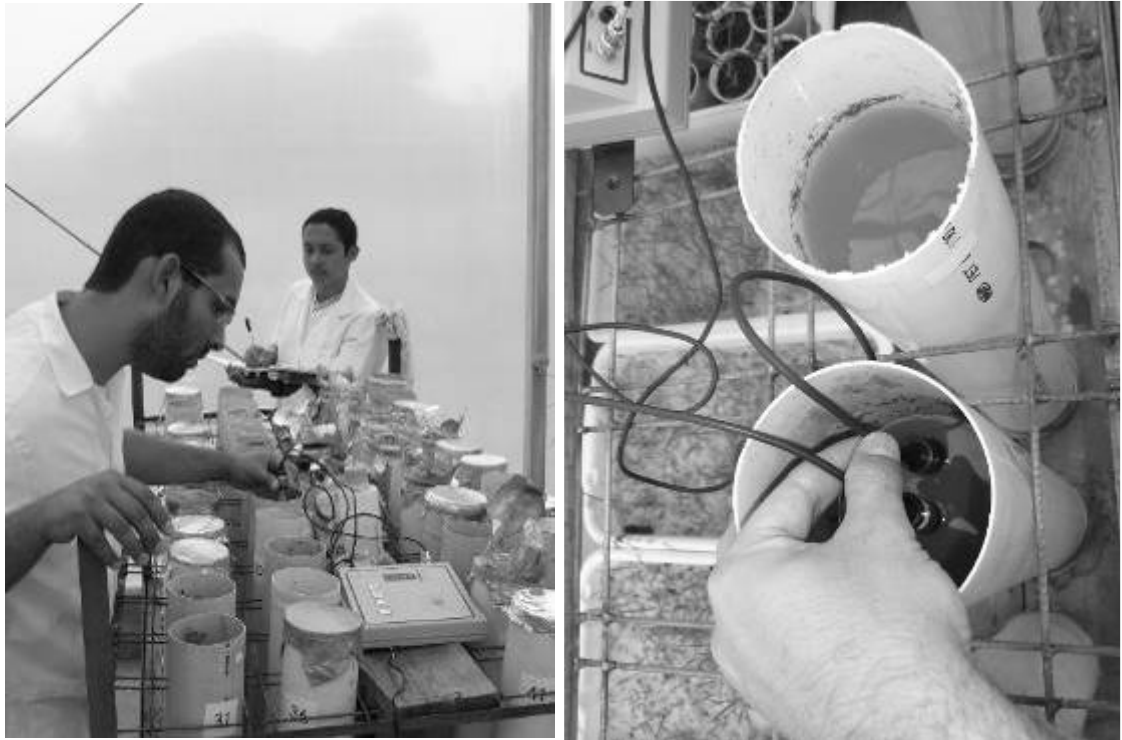
Figura 37. Determinação de forma direta do pH e potencial redox no ensaio com colunas de lixiviação.
