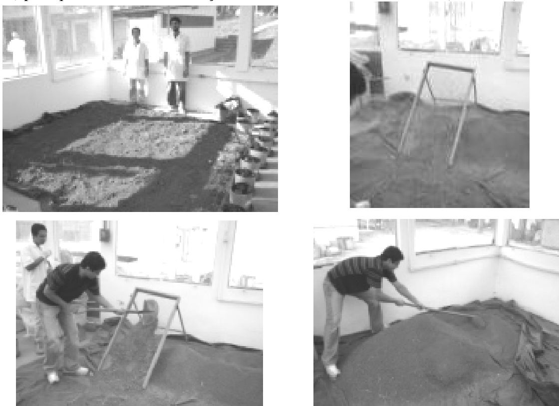
Figura 29. Fotos com a sequência no preparo dos solos: secagem, destorroamento, peneiramento e homogeneização.
