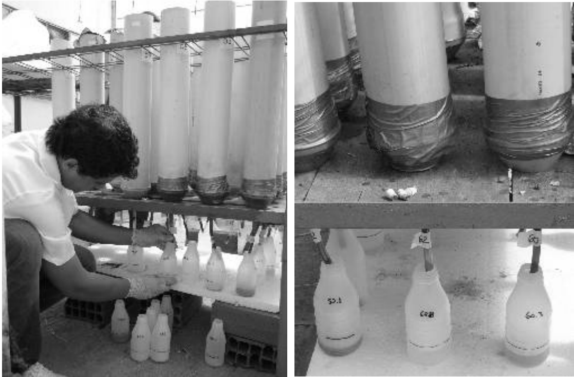
Figura 38. Coleta dos volumes referentes a maior chuva nos últimos 40 anos, proposto no ensaio de lixiviação. Em cada frasco foi coletado volume de 100 mL, corresponde a 1/16 do volume poro.
