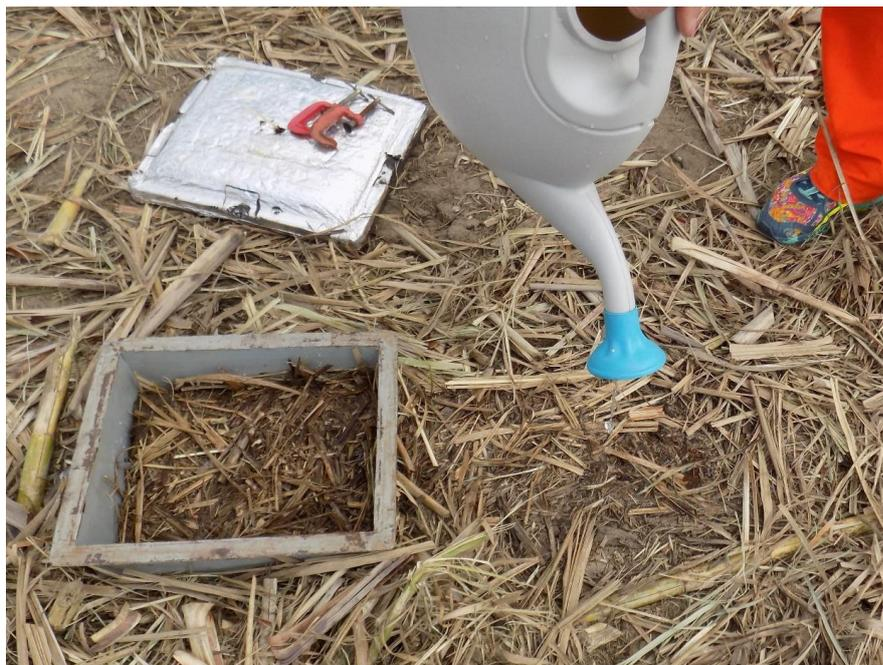
**Figura 34.** Aplicação de lâminas d'água no interior das câmaras estáticas e em área igual à da câmara, ao seu lado, em Linhares-ES, no período de coleta de gases do efeito estufa.
