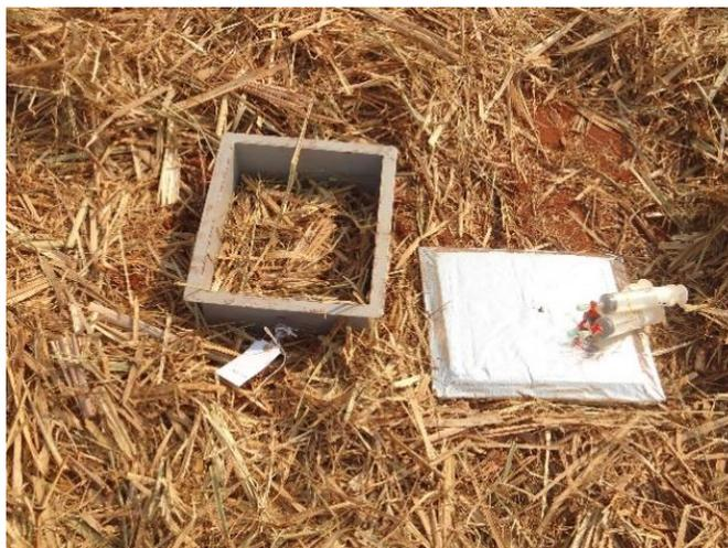
**Figura 6.** Câmara coletora de GEE inserida no solo no tratamento 2 (50% de palha sobre a superfície do solo), em Colorado (PR).
