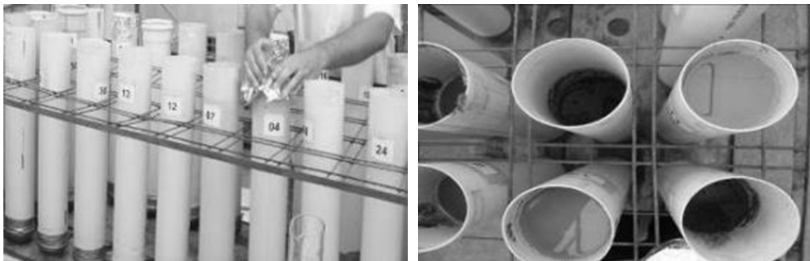
Figura 6. Colunas com resíduos de perfuração de poços de petróleo, em PVC, utilizadas no ensaio de lixiviação
