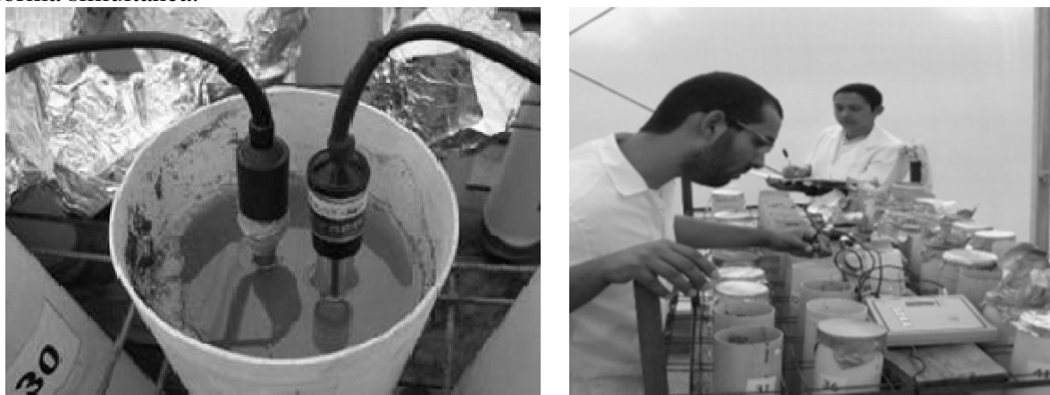
Figura 7. Leituras de pH e Eh nas colunas de lixiviação.
