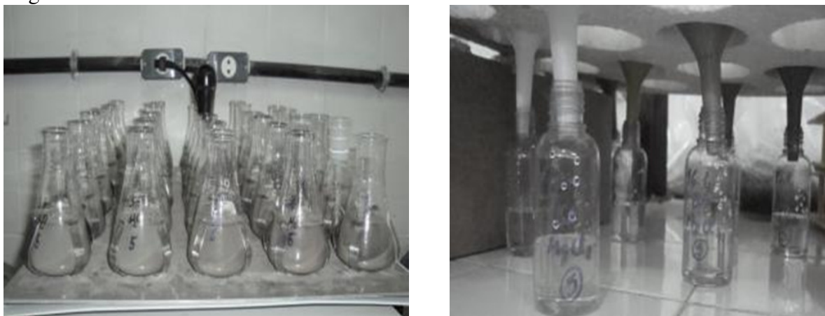
Figura 5. Esquema de agitação orbital e filtração lenta.
