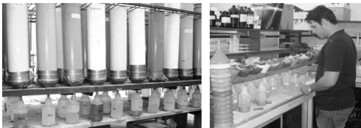
Figura 8. Coleta do lixiviado em frascos de 500 ml e filtração lenta dos extratos que apresentavam partículas de resíduo em suspensão.
