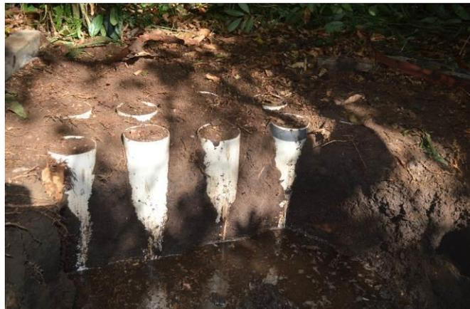
**Figura 11.** Ilustração dos procedimentos da coleta das amostras indeformadas nas colunas de tubo PVC (Fotos: Paula F. C. Soares).
