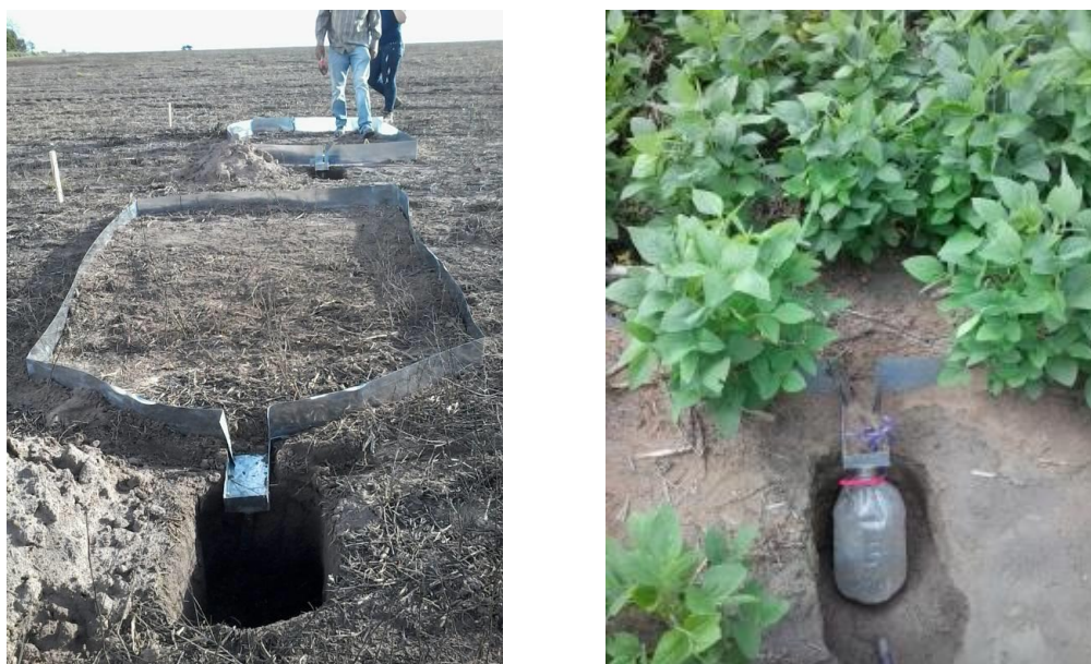
Figura 6. Parcela de perda de solo após a instalação (à esquerda) e com plantas de soja aos 44 dias após emergência (florescimento) e detalhe do coletor de enxurrada.
