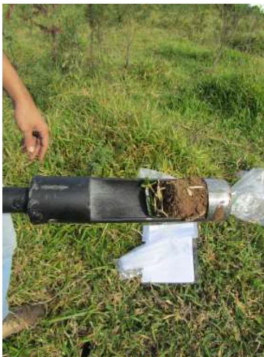
Figura 9. Trado de coleta de solo para amostragem da mesofauna edáfica.
