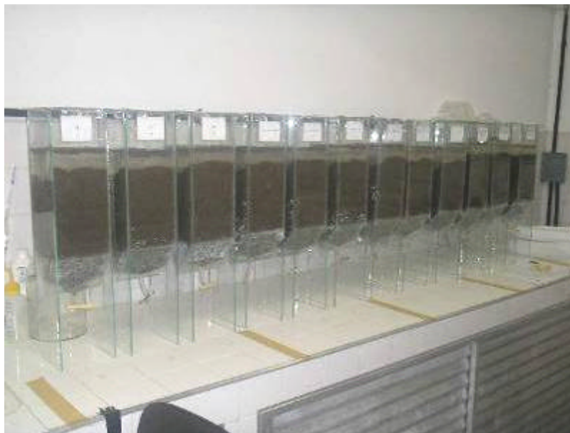
Figura 8. Experimento em colunas de vidro, relativo a um dos três grupos de substratos estudados (G1, G2 e G3).
