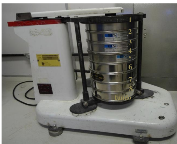
Figura 31. Analisador de Partículas (1) 60 mesh, (2) 70 mesh, (3) 100 mesh, (4) 120 mesh, (5) 140 mesh, (6) 170 mesh, (7) 200 mesh, (8) fundo.
