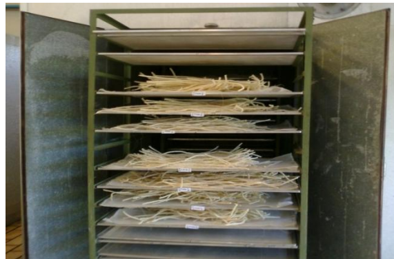
Figura 8. Processo de secagem dos extrudados de cascas e albedo de maracujá e arroz em secador de bandejas. Autora: Valéria F. de Souza.
