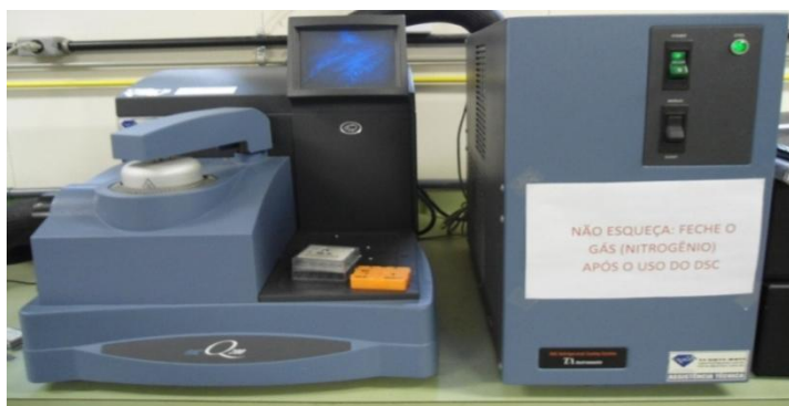
Figura 19. Equipamento Calorímetro diferencial de varredura. Autora: Valéria F. de Souza.
