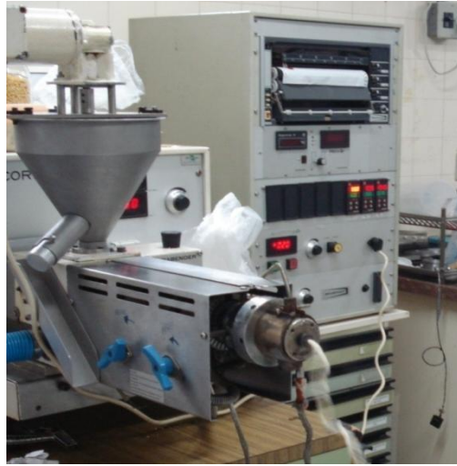
Figura 7. Extrusora monrosca da marca Brabender Autora: Valéria F. de Souza.
