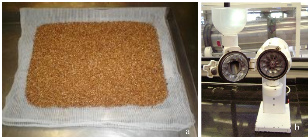
Figura 7. a. Grãos de sorgo, b. Moinho de disco Laboratory Mill 3600, Perten (Suécia) (Créditos: Gaspar D. M. Ramos).
