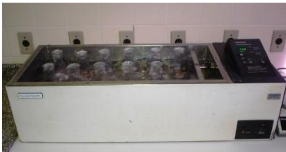
Figura 8. Banho-maria com agitação, modelo 50, Precision Scientific (Chicago, EUA) (Créditos: Gaspar D. M. Ramos).
