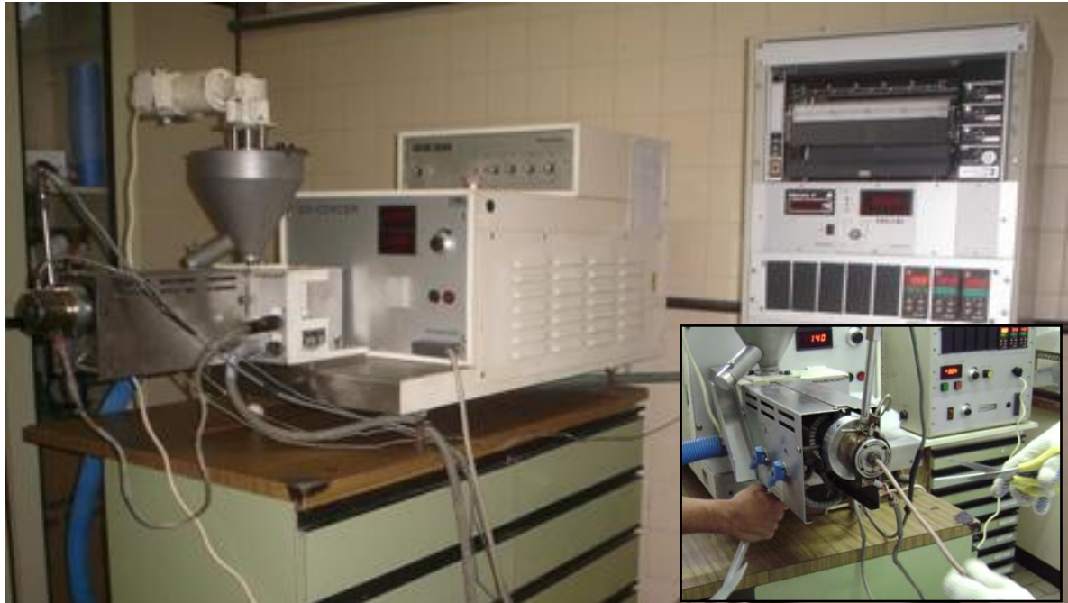
Figura 23. Extrusora monorosca, modelo DSE-20DN, Brabender (Duisburg, Alemanha) (Créditos: Gaspar D. M. Ramos).
