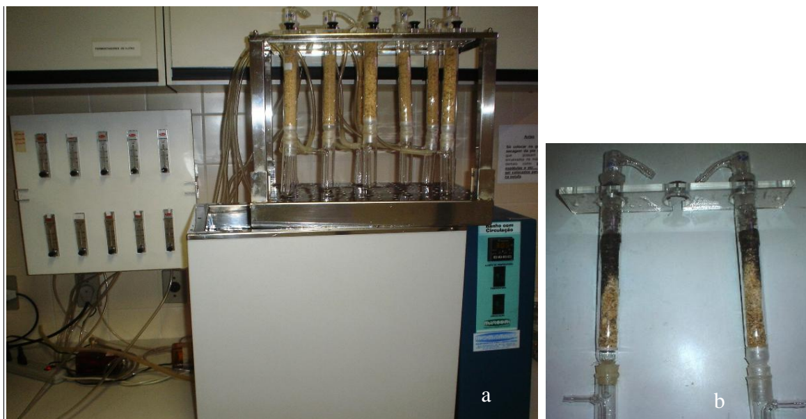
Figura 6. a. Sistema para FES em colunas de vidro com aerção e temperatura controladas, b. Colunas após fermentação (Créditos: Gaspar D. M. Ramos).
