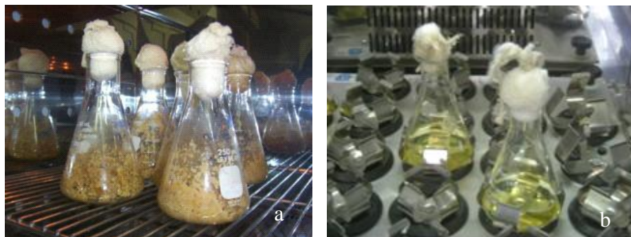
Figura 5. Exemplificação de FES (a) e FSm (b) em escala de laboratório (FERNANDES, 2007).
