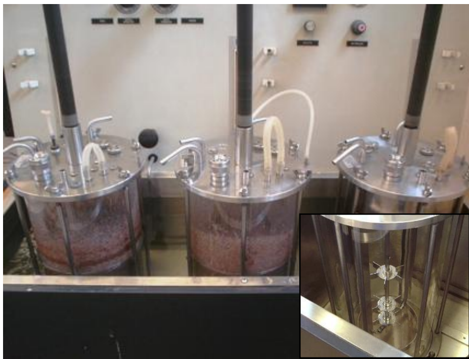
Figura 21. Fermentador Drive Assembly, modelo FS-414, marca New Brunswick Scientific (Nova Jersey, EUA) (Créditos: Gaspar D. M. Ramos).
