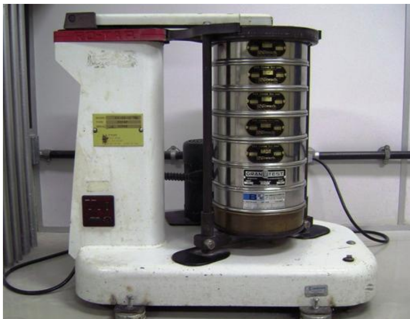
Figura 9. Agitador de peneiras RO-TAP, modelo RX-29-10 (Mentor, EUA) (Créditos: Gaspar D. M. Ramos).
