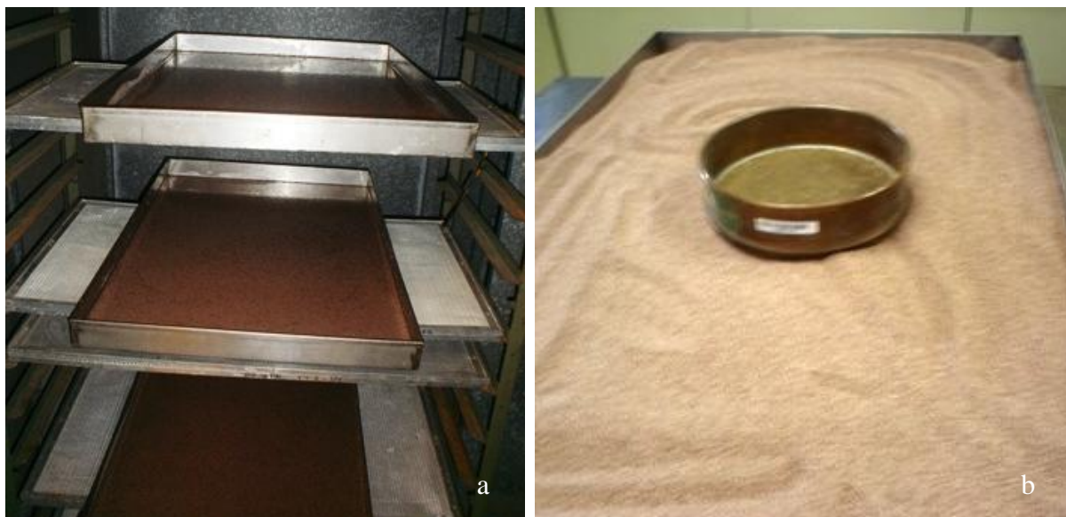
Figura 22. a. Secador adiabático com ventilação forçada, tipo cabine, b. Farinha peneirada usando peneira de 12 mesh (1700 \mu m) (Créditos: Gaspar D. M. Ramos).
