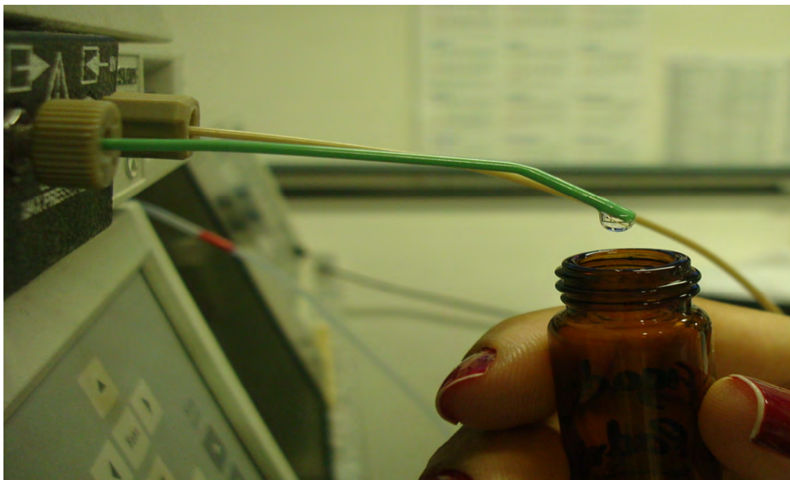
Figura 15: Isolamento do padrão de retinol a partir da coleta no ápice do pico cromatográfico
