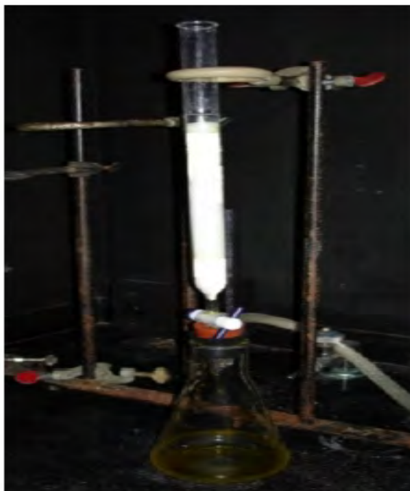
Figura 16: Preparação da coluna cromatográfica aberta para separação do padrão de beta-caroteno
