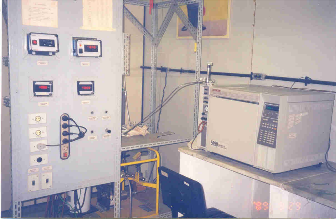
Figura 3.3: Foto do aparato utilizado neste estudo, para extração contínua e análise cromatográfica acoplada.
