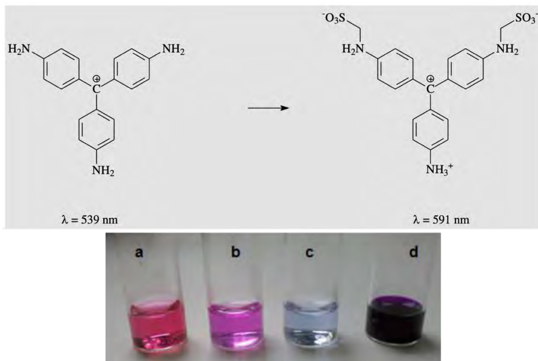
Figura 28 – Exemplo de deslocamento batocrômico na p -rosanilina pela alteração dos seus grupos amina para grupos aminosulfônicos. a) p -rosanilina; b) mistura de p -rosanilina e o seu análogo aminossulfonado; c) análogo aminossulfonado e d) análogo aminossulfonado em maior concentração. Figura obtida de MARTINS (2015).
