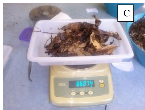
Figura III. 4: A) Imersão da serrapilheira em água por 90 minutos para encharcamento da amostra; B) Drenagem do excedente por 30 minutos em bandejas dispostas com 30% de declividade; C) Pesagem da serrapilheira.
