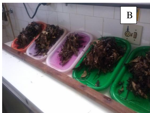
Figura III. 4: A) Imersão da serrapilheira em água por 90 minutos para encharcamento da amostra; B) Drenagem do excedente por 30 minutos em bandejas dispostas com 30% de declividade; C) Pesagem da serrapilheira.
