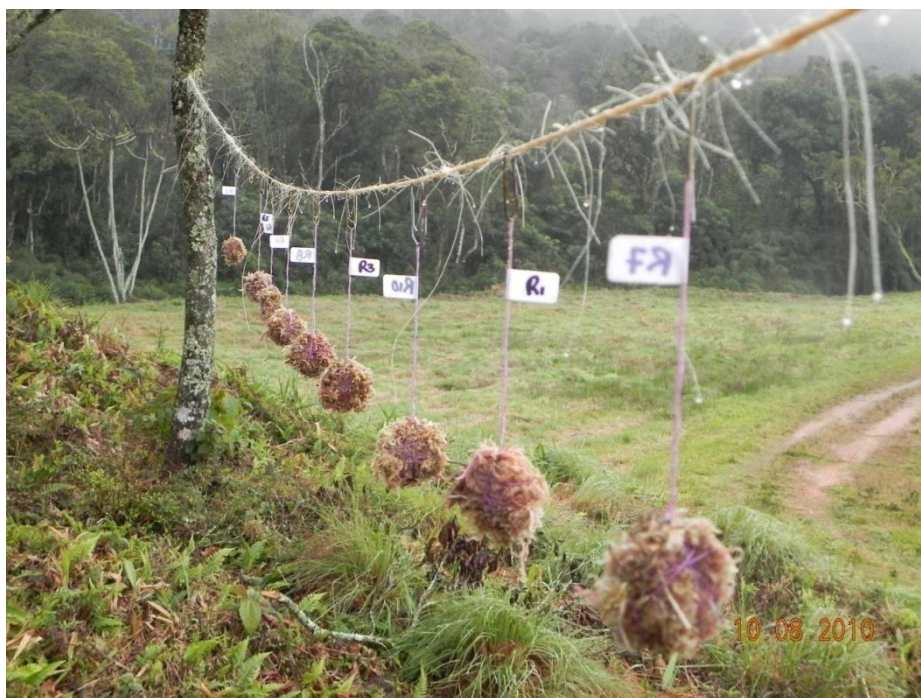
Figura II-3: Interceptadores de nevoeiro disposto em campo para medir retenção de umidade atmosférica durante 24h, Nova Friburgo - RJ.
