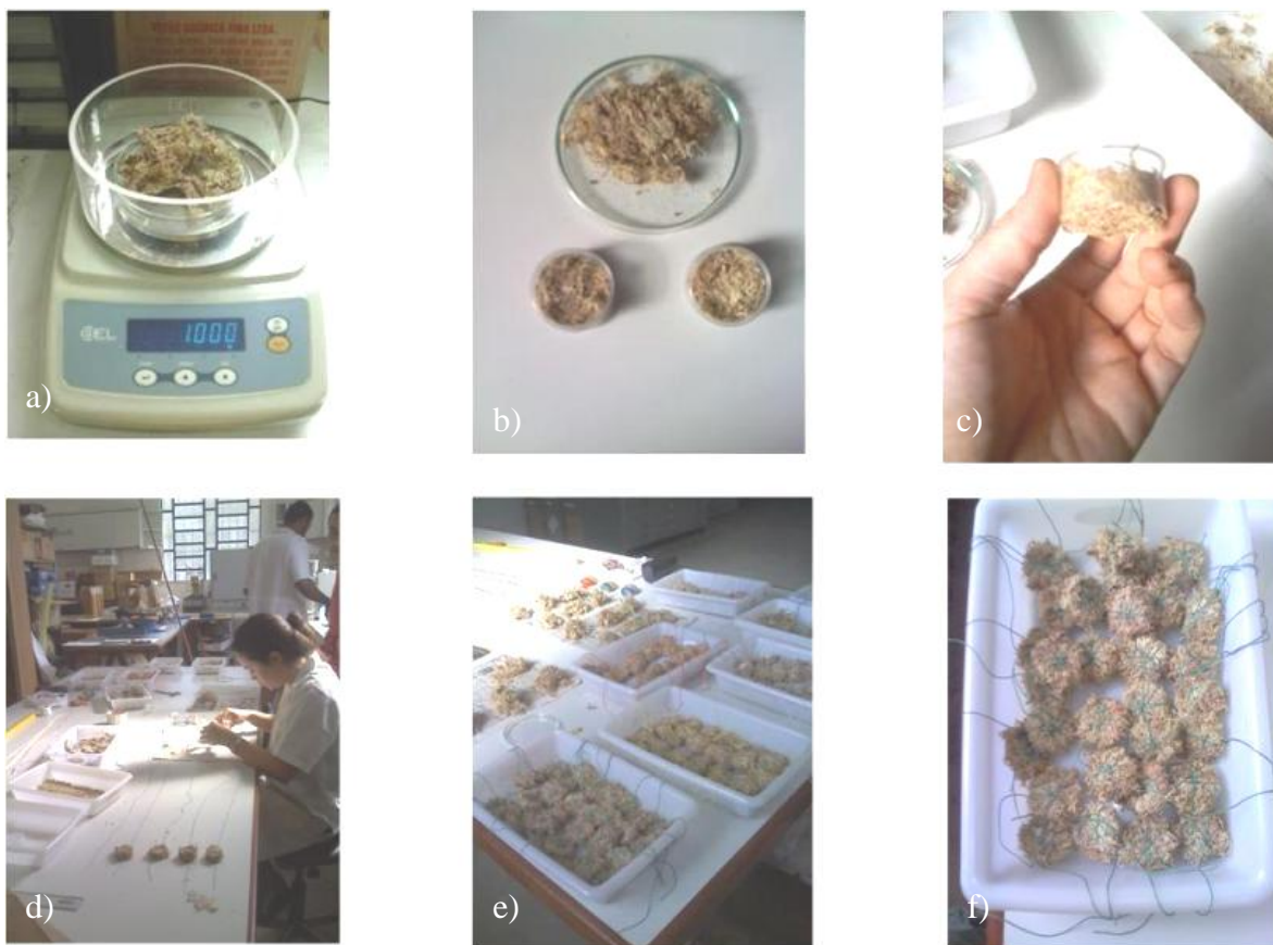
Figura II-2: Metodologia para confecção dos interceptadores de umidade onde: a) e b) pré-pesagem do Sphagnum seco; c) Sphagnum prensado na forma rígida; d) amarração de amostra; e) e f) interceptadores prontos para alocação no campo.
