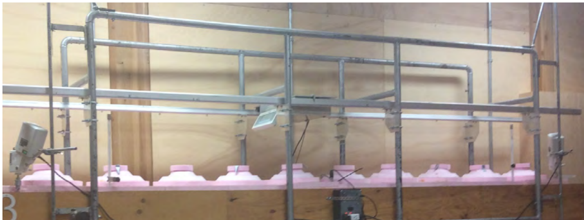
Figura 3. Aspecto geral do dispositivo utilizado para o ensaio de sorção, composto por 10 células de sorção (dessecadores) (Centre de Recherche sur les Matériaux Renouvelables – CRMR, Université laval, Canadá).
