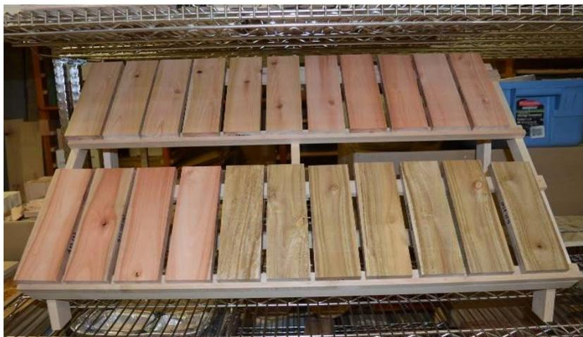
**Figura 34.** Suporte com inclinação de 45° utilizado para o acondicionamento das amostras de madeira, antes e após a aplicação do verniz.
