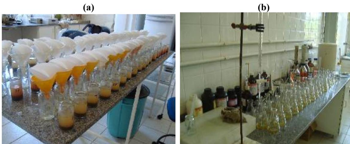
**Figura 9.** Filtrado do material extraído (a) e material para análise do ponto estequiométrico da volumetria de oxi-redução (b), das amostras coletadas nos sistemas de manejo com bananeiras.
