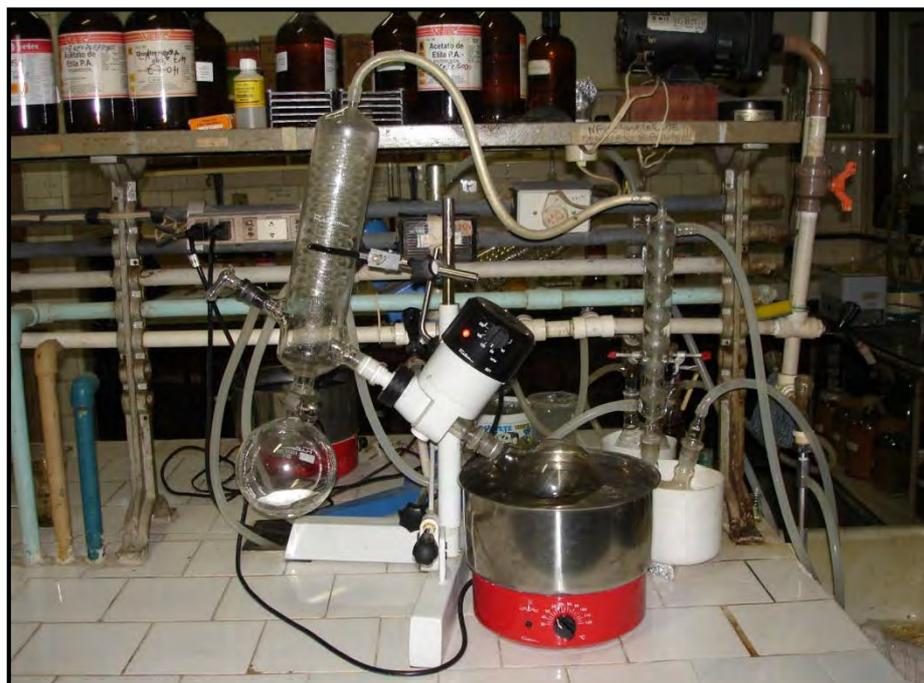
**Figura 12.** Concentração do extrato filtrado por meio de rota-evaporador.
